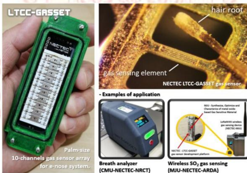
ภาพที่ 2-3 การใช้ประโยชน์ของแก๊สเซ็นเซอร์ชนิดสารกึ่งตัวนำโลหะออกไซด์ [29]
