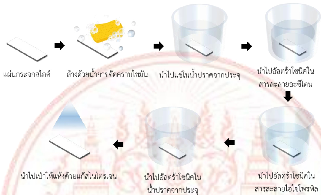
ภาพที่ 3-15 กระบวนการทำความสะอาดแผ่นกระจกสไลด์
