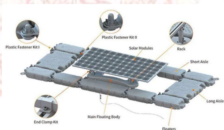
ภาพที่ 2-7: ระบบผลิตไฟฟ้าพลังงานแสงอาทิตย์แบบทุ่นลอยน้ำ
