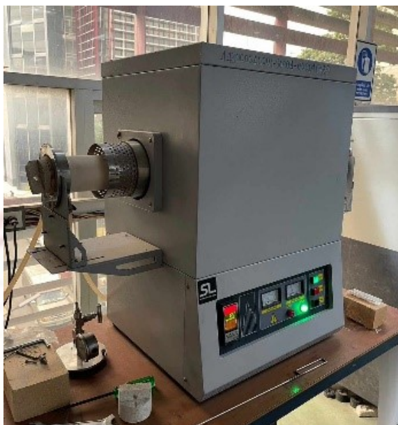
ภาพที่ 3-4 เตาเผาผนึกควบคุมบรรยากาศแนวนอน
