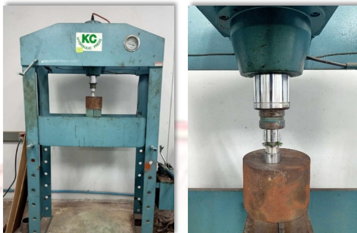
ภาพที่ 3-2 เครื่องอัดระบบไฮดรอลิก 30 ตัน ยี่ห้อ KC Hydraulic press
