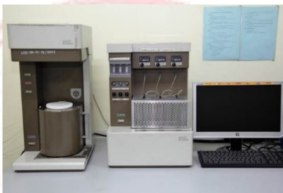
ภาพที่ 3-9 เครื่องวิเคราะห์ขนาดพื้นที่ผิวจำเพาะและปริมาตรรูพรุน ยี่ห้อ BELSORP-mini II
