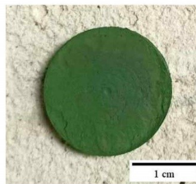
รูปที่ 1 โครเมียมออกไซด์ผงอัดขึ้นรูป
