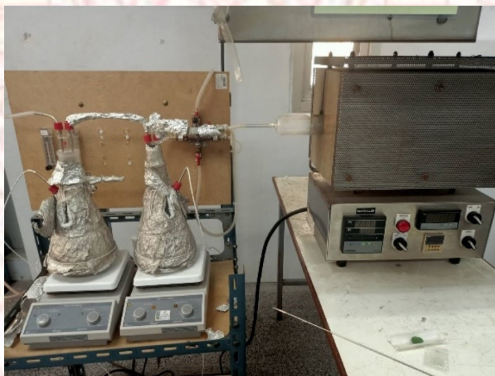
ภาพที่ 3-6 เครื่องทำความชื้นต่อเข้ากับเตาอบควบคุมบรรยากาศแนวนอน
