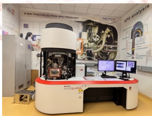
ภาพที่ 3-12 เครื่องมือวิเคราะห์วัสดุนาโนโดยเทคนิคอิเล็กโตรสโคปีโฟโตอิเล็กตรอนด้วยรังสีเอกซ์
