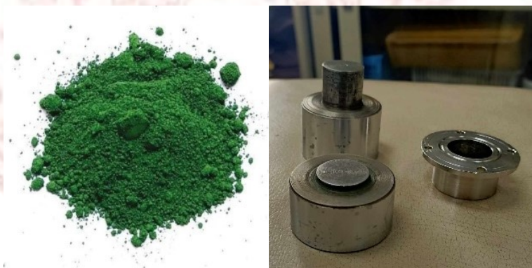
ภาพที่ 3-1 ผงโครเมียมออกไซด์ (ซ้าย) และเบ้าขึ้นรูป (ขวา)
