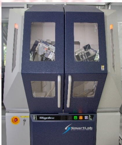
ภาพที่ 3-10 เครื่องวิเคราะห์การเลี้ยวเบนของรังสีเอ็กซ์ ยี่ห้อ Rigaku รุ่น SmartLab
