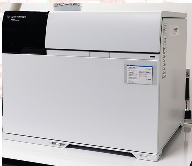
ภาพที่ 3-8 เครื่องวิเคราะห์องค์ประกอบธาตุ Inductively coupled plasma-mass spectrometer (ICP-MS) ยี่ห้อ Agilent รุ่น 7900 ICP-MS
