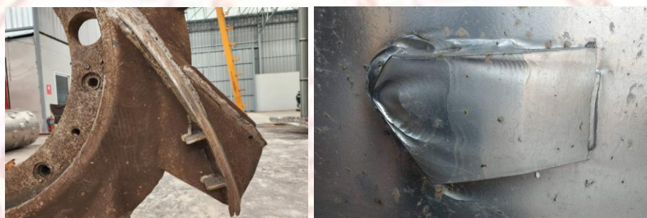
ภาพที่ 2-1 กลไกการสึกหรอทางกลที่เกิดจากการขีดถู
