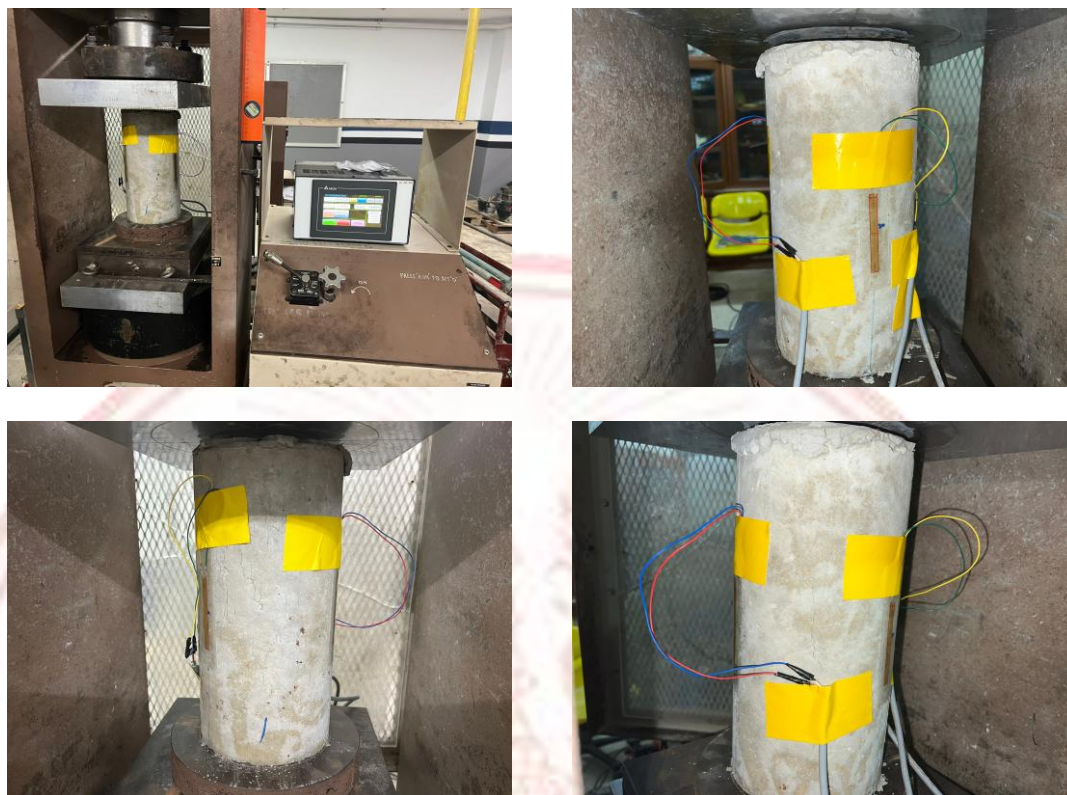
รูปที่ 3.1-3 การทดสอบกำลังรับแรงอัด
