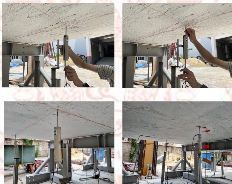
รูปที่ 3.4-4 การติดตั้งอุปกรณ์ตรวจวัดการเสียรูปของพื้นสะพานจำลอง
