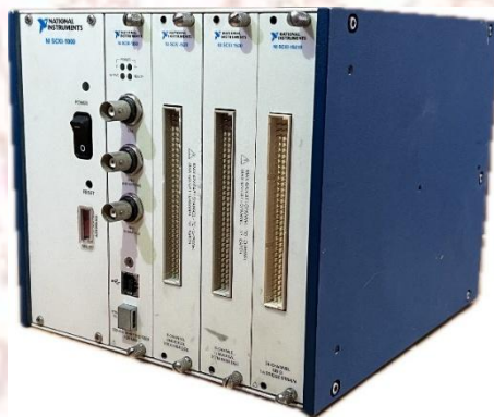
รูปที่ 3.3-3 อุปกรณ์แปลงสัญญาณ A to D (Data Logger)
