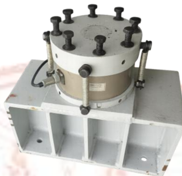
รูปที่ 3.3-2 มาตรวัดแรง (Load Cell)
