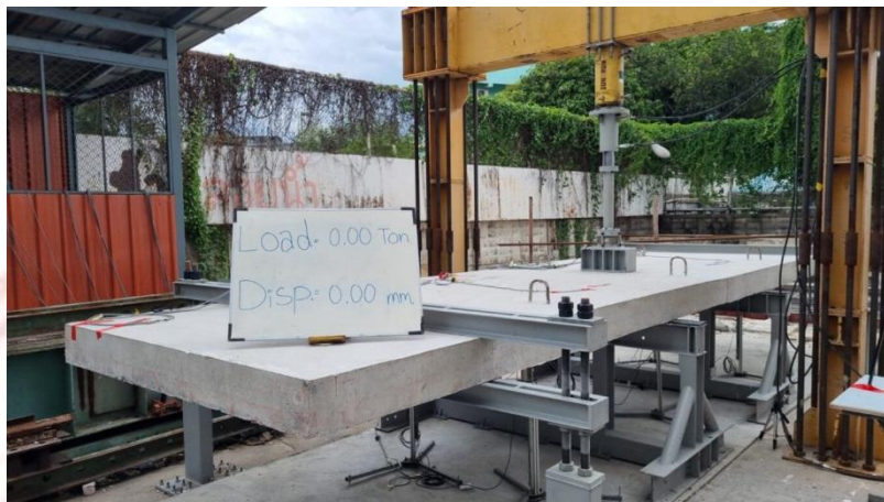
รูปที่ 3.5-1 การทดสอบกำลังรับแรง
