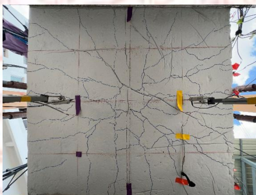
รูปที่ 4.1-6 รายละเอียดการแตกร้าวของพื้นสะพานจำลอง (ST-CRC20-1)
