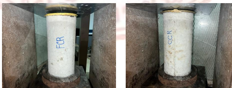
รูปที่ 3.1-2 การทดสอบกำลังรับแรงอัดของตัวอย่างคอนกรีต
