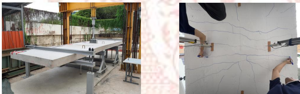
รูปที่ 3.6-2 ตัวอย่างการตรวจวัดเปอร์เซ็นต์การแตกร้าว
