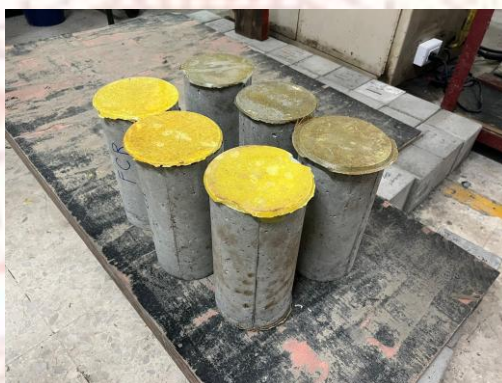
รูปที่ 3.1-1 คอนกรีต (Cylinder) ขนาด 15 x 30 เซนติเมตร
