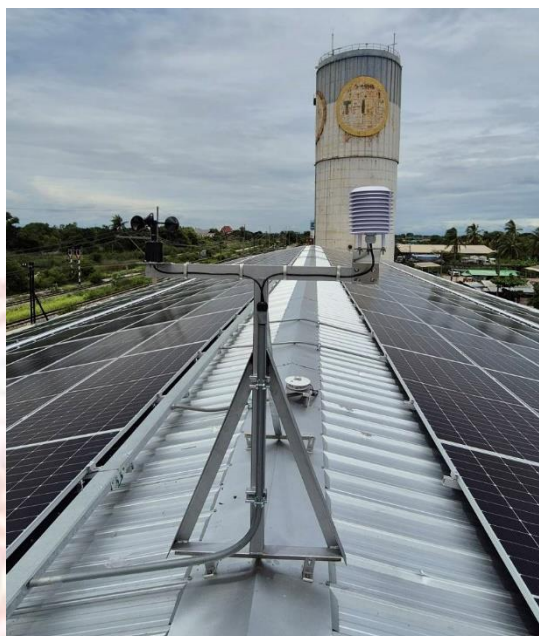
(รูปที่ 3.2 อุปกรณ์ตรวจวัดรังสีอาทิตย์และอุณหภูมิที่ติดตั้งบนหลังคาสำหรับการเก็บข้อมูลวิจัย)
