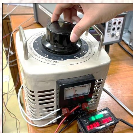
ภาพที่ 3-13 หมุนหม้อแปลงปรับแรงดันที่จ่ายกำลังไฟฟ้าให้แผ่นทำความร้อน
