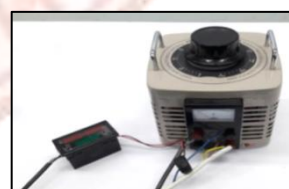
(ข) หม้อแปลงปรับแรงดัน
