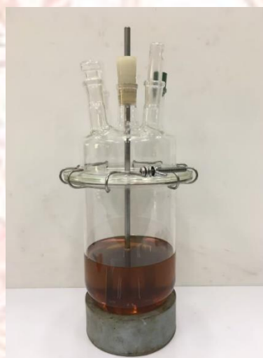
ภาพที่ 3-1 ชุดอุปกรณ์สังเคราะห์พอลิออลจากน้ำมันปาล์มที่ใช้แล้ว
