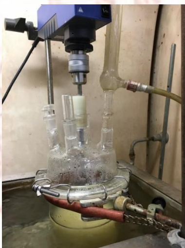
ภาพที่ 3-1 ชุดอุปกรณ์สังเคราะห์พอลิออลจากน้ำมันปาล์มที่ใช้แล้ว
