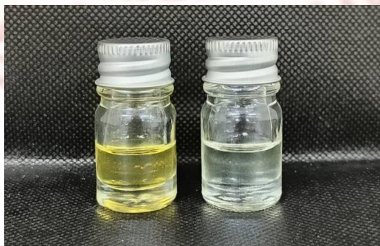
ภาพที่ 4-1 ลักษณะทางกายภาพของน้ำมันปาล์มที่ใช้แล้วและน้ำมันปาล์มที่ใช้แล้วตัดแปร
