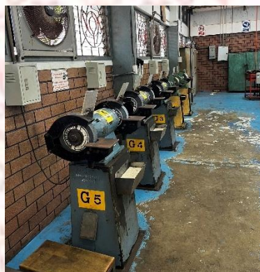
ภาพที่ 3-4 เครื่องจักร ในการลับคมเครื่องมือตัดมีดกลึงเกลียว
