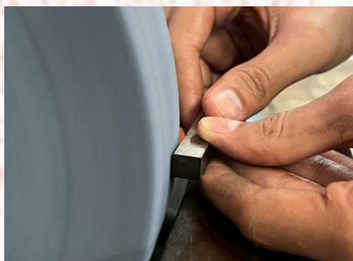
ภาพที่ 2-34 แสดงการลับมุมหลบด้านข้างขวา
