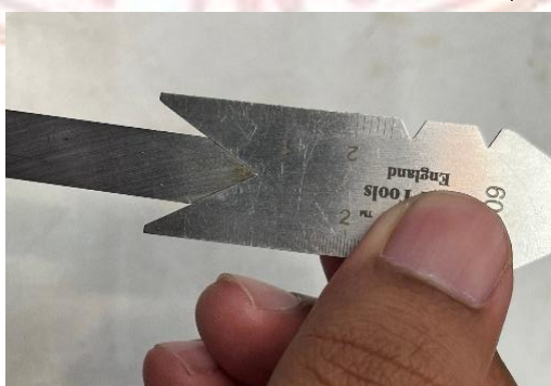
ภาพที่ 2-35 แสดงการวัดตรวจสอบมุมรวมปลายมีด
