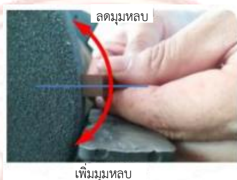
ภาพที่ 2-38 แสดงแนวในการแก้ไขมุมหลบด้านข้างขวา
