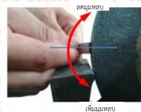
ภาพที่ 2-32 แสดงแนวในการแก้ไขมุมหลบด้านข้างซ้าย (ที่มา : สุรัชย์ บุญโสภณ 2559)
