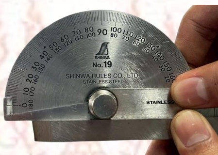
ภาพที่ 2-42 แสดงการวัดตรวจสอบมุมคายหลังมีด
