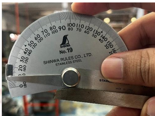
ภาพที่ 2-29 แสดงการวัดตรวจสอบมุมเอียงด้านแรก 30 องศา
