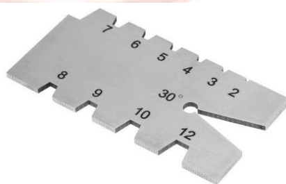
ภาพที่ 2-44 แสดงลักษณะของเกจเกลียวสี่เหลี่ยมคางหมู (Trapezoid Thread Gage)
