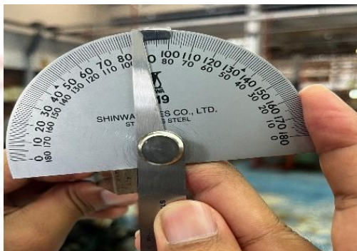
ภาพที่ 2-36 แสดงการวัดตรวจสอบมุมหลบด้านข้างขวา
