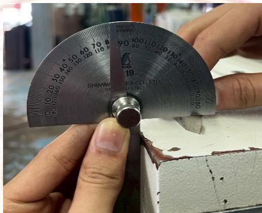
ภาพที่ 2-40 แสดงการวัดตรวจสอบมุมคายข้าง
