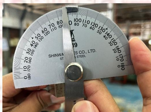
ภาพที่ 2-30 แสดงการวัดตรวจสอบมุมหลบด้านข้างซ้าย
