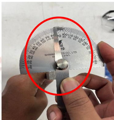
ภาพที่ 3-9 ตรวจสอบมุมหลบด้านข้าง กำหนดมุม 4 องศา
