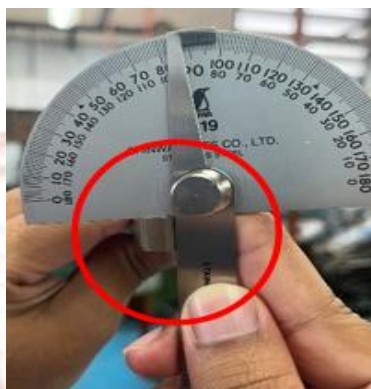
ภาพที่ 3-12 ตรวจสอบมุมหลบด้านข้าง กำหนดมุม 4 องศา
