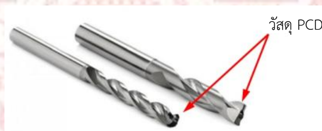
ภาพที่ 2-8 แสดงลักษณะของชิ้นส่วนแผ่น PCD นำมายึดกับปลายดอกสว่าน
