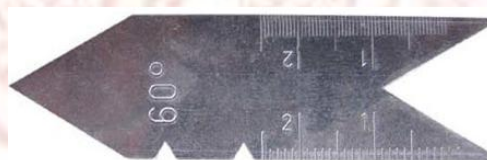
ภาพที่ 2-43 แสดงลักษณะของเกจวัดมุมเกลียวสามเหลี่ยม (Center Gage)
