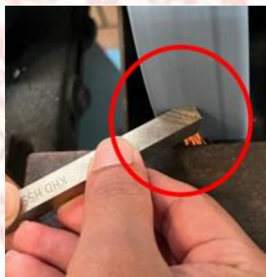
ภาพที่ 3-7 ลับมุมที่ 1 และมุมหลบด้านซ้าย
