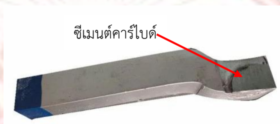
ภาพที่ 2-3 มิตตัดซีเมนต์คาร์ไบด์แบบมิตเล็บที่ต้องใช้การบัดกรียึดกับฐานรองรับ
