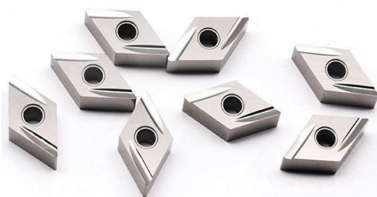
ภาพที่ 2-6 แสดงเครื่องมือตัดแบบเม็ดมิดที่ผลิตจากเซอร์เมท
