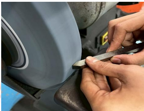
ภาพที่ 2-33 แสดงการลับมุมเอียงด้านที่ 2 ให้เกิดมุมรวมปลายมีด 60 องศา
