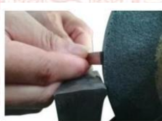
ภาพที่ 2-28 แสดงการลับมุมหลบด้านข้างซ้าย
