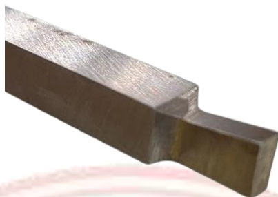
ภาพที่ 2-20 แสดงลักษณะมีดกลึงเซาะร่อง (ที่มา : สุรชัย บุญโสภณ 2559)
