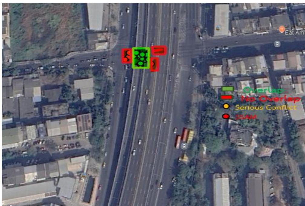
ภาพที่ 4-86 ตำแหน่งที่ซ้อนทับกันของการชนที่จุดตัด (Crossing) บริเวณทางแยกรูป + ในช่วงเวลาทำงาน ระหว่างโปรแกรม SSAM กับ วิธี Swedish TCT
