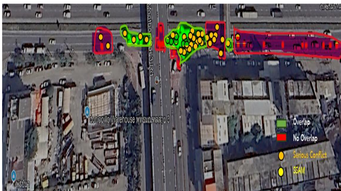
ภาพที่ 4-61 ตำแหน่งที่ซ้อนทับกันของการชนท้าย (Rear-End) บริเวณทางแยกรูป T ในช่วงเวลาทำงาน ระหว่างโปรแกรม SSAM กับ วิธี Swedish TCT
