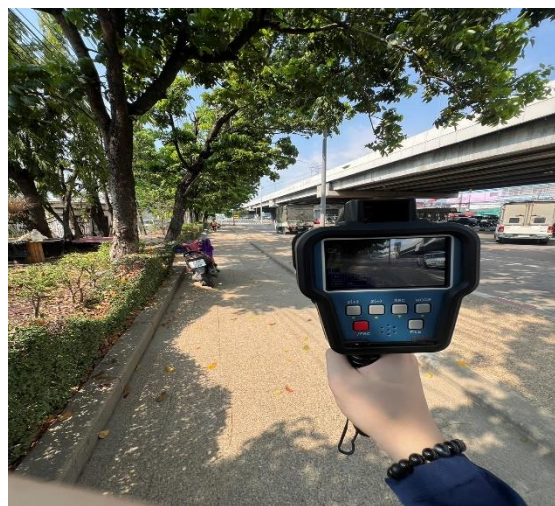
ภาพที่ 3-6 ตัวอย่างการเก็บข้อมูลความเร็วโดยใช้กล้อง Radar Gun
