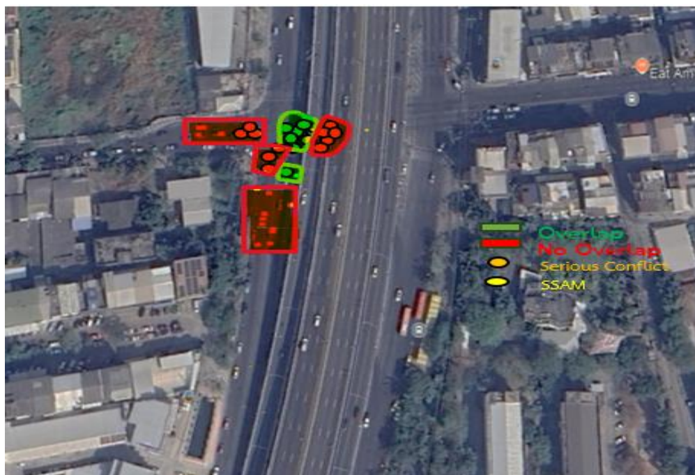
ภาพที่ 4-82 ตำแหน่งที่ซ้อนทับกันของการชนท้าย (Rear-End) บริเวณทางแยกรูป T+ ในช่วงเวลาทำงาน ระหว่างโปรแกรม SSAM กับ วิธี Swedish TCT
