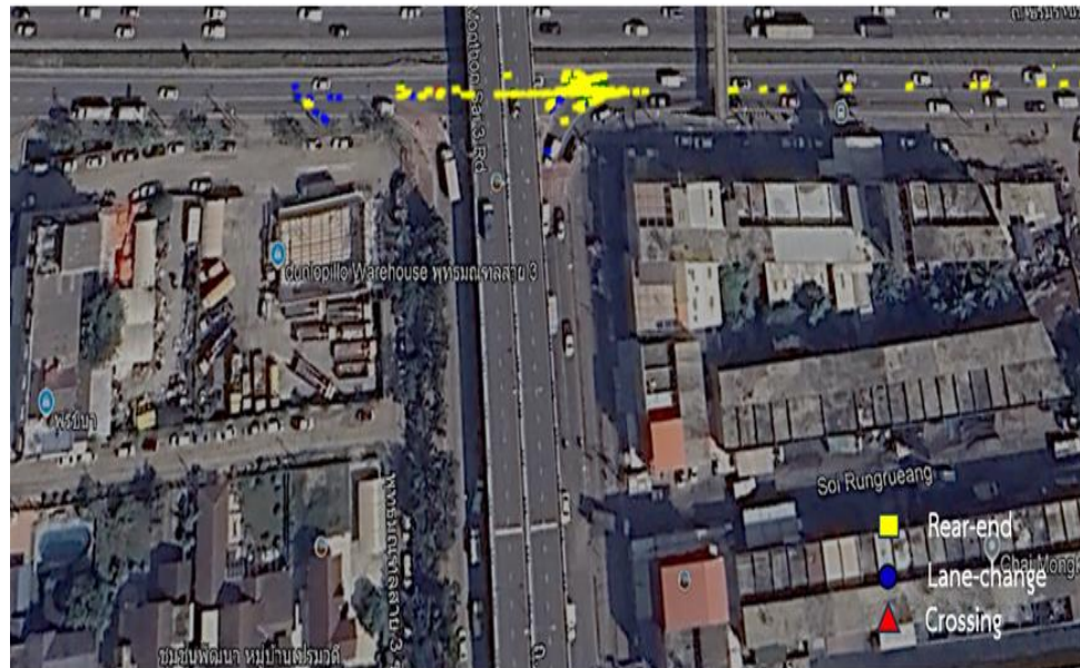
ภาพที่ 3-18 ตัวอย่างผลลัพธ์จากการวิเคราะห์โปรแกรมSSAM แสดงรูปแบบของการชน
