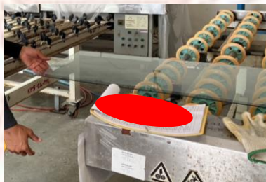
ภาพที่ 3-9 การทำงานของพนักงานปฏิบัติงานกระจกวางที่ลูกกลิ้งลำเลียง
