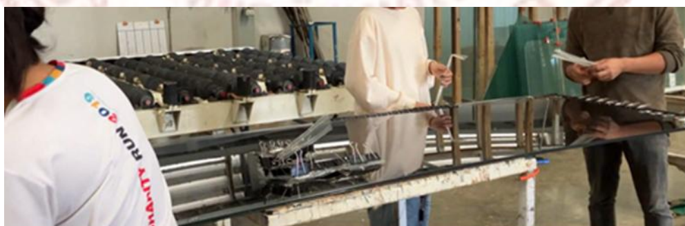
ภาพที่ 4-21 กระบวนการติดก๊ิบของพนักงานในสถานีการกรีดฟิล์มติดก๊ิบบนกระจก
