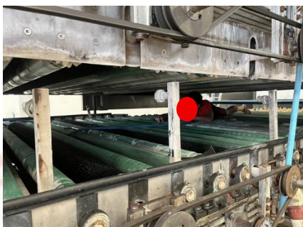
ภาพที่ 4-8 การทำความสะอาดเครื่องล้างกระจก
