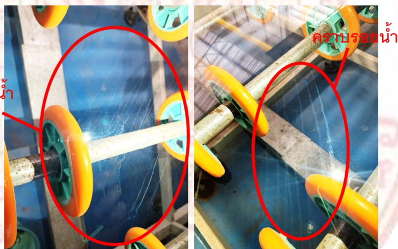
ภาพที่ 4-5 คราบรอยน้ำที่เกิดขึ้นหลังจากกระบวนการล้างทำความสะอาดโดยเครื่องล้าง
