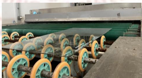
ภาพที่ 3-10 กระจกไหลเข้าเครื่องล้าง
