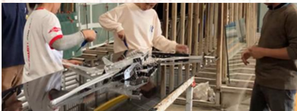
ภาพที่ 4-20 กระบวนการนำก๊ิบออกมาแยกก่อนการติดก๊ิบ
