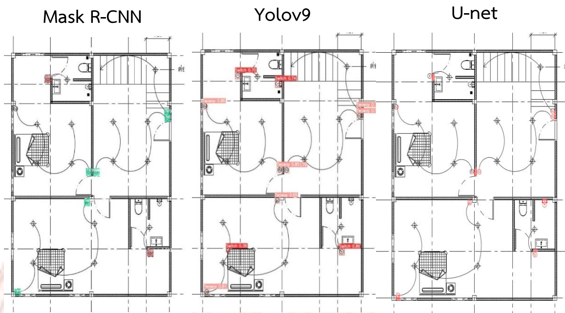
ภาพที่ 4-8 ตัวอย่างผลลัพธ์จากการตรวจจับสวิตช์ไฟ
