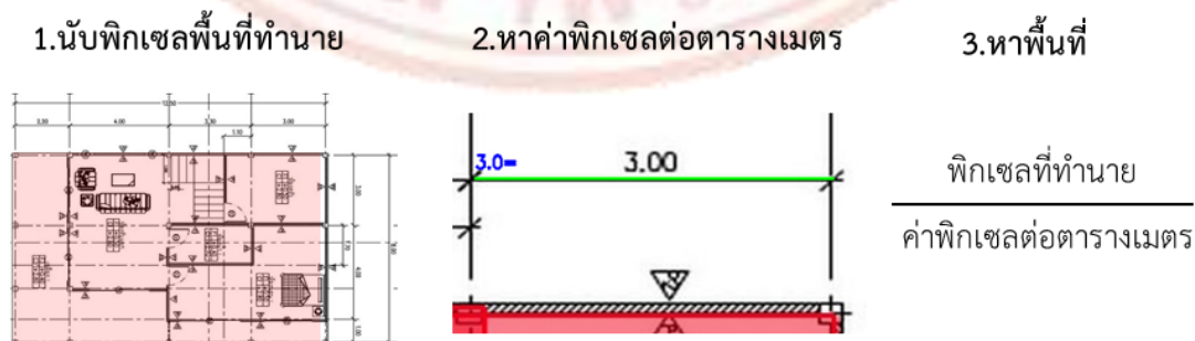
ภาพที่ 3-10 ขั้นตอนการแปลงจากหน่วยพิกเซลให้เป็นหน่วยตารางเมตร
