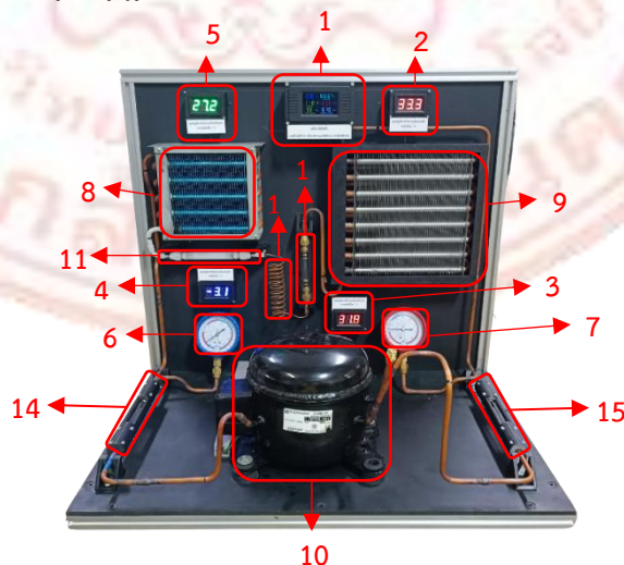
ภาพที่ 4-1 ส่วนประกอบชุดสาธิตการเปลี่ยนสถานะสารทำความเย็นเครื่องทำความเย็นระบบอัดไอ
