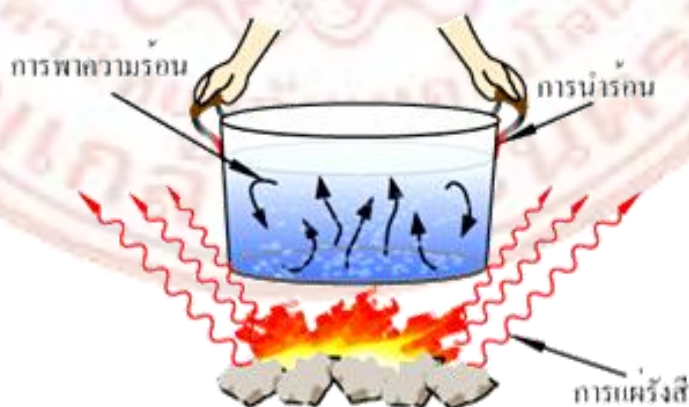
ภาพที่ 2-8 การการถ่ายเทความร้อน (Heat Transfer)
