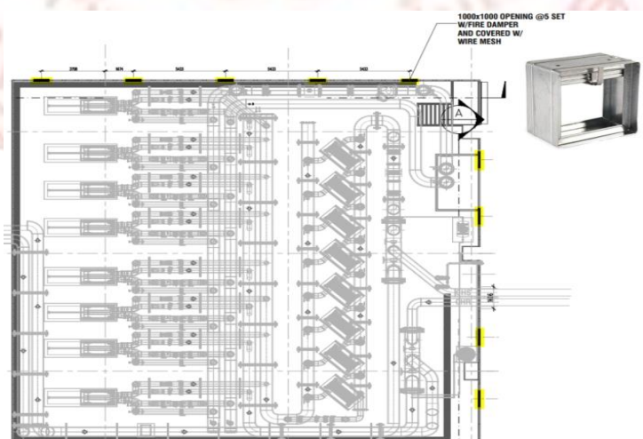
ภาพที่ 4-11 ตำแหน่งติดตั้งอุปกรณ์ป้องกันไฟลาม อาคารที่ 2
