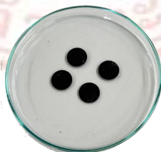
ภาพที่ 3-4 แผ่นนิกเกิลโพลีขั้วไฟฟ้า (RE2, RE4, และ RE6) หลังอบแห้ง
