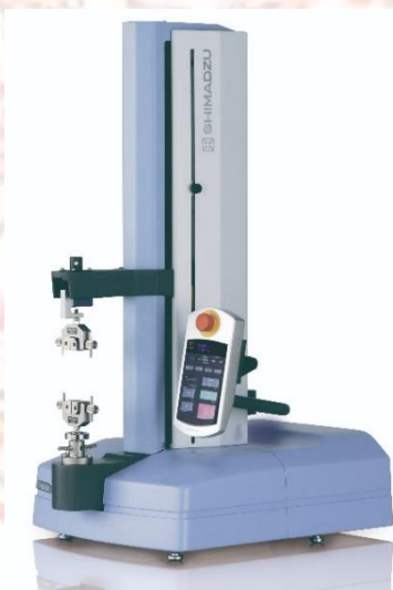
ภาพที่ 3-22 เครื่องวิเคราะห์เนื้อสัมผัส ยี่ห้อ Shimadzu/ EZ-Test(EZ-LX) ที่มา : https://tsen.in.th/texture-analyzer/
