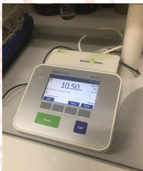
ภาพที่ 3-6 การใช้เครื่อง pH meter เพื่อรักษาค่า pH ไว้ที่ 10.5
