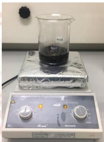
ภาพที่ 3-2 การปรับสภาพผงกะลามะพร้าวด้วยสารละลายโซเดียมไฮดรอกไซด์
