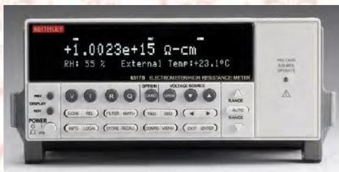
ภาพที่ 3-24 เครื่องวัดสัญญาณทางไฟฟ้า Electrometer ยี่ห้อ Keithley รุ่น 6517B
