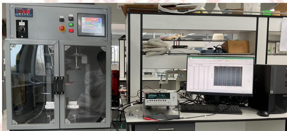
ภาพที่ 3-27 การทดลองชุดอุปกรณ์ทดสอบแรงกดของฟิล์มนาโนเซลล์โลส
