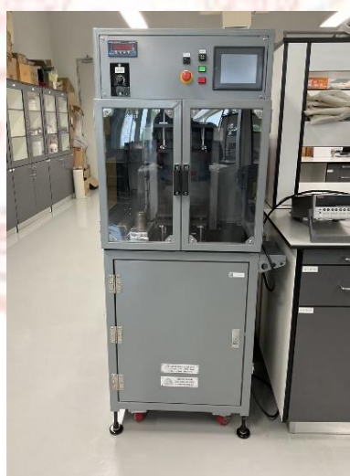
ภาพที่ 3-23 เครื่องทดสอบแรงกด รุ่น AAS-Q101
