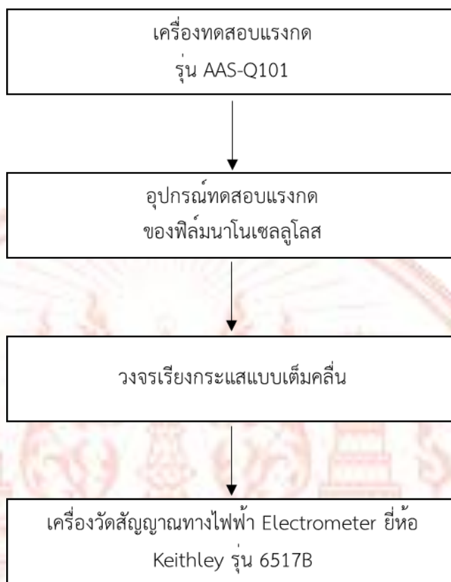
ภาพที่ 3-25 ไดอะแกรมของชุดทดลองอุปกรณ์ทดสอบแรงกดของฟิล์มนาโนเซลล์โลส
