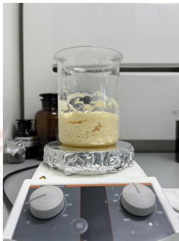
ภาพที่ 3-3 การฟอกสีไม้ยางพาราด้วยสารละลายกรด
