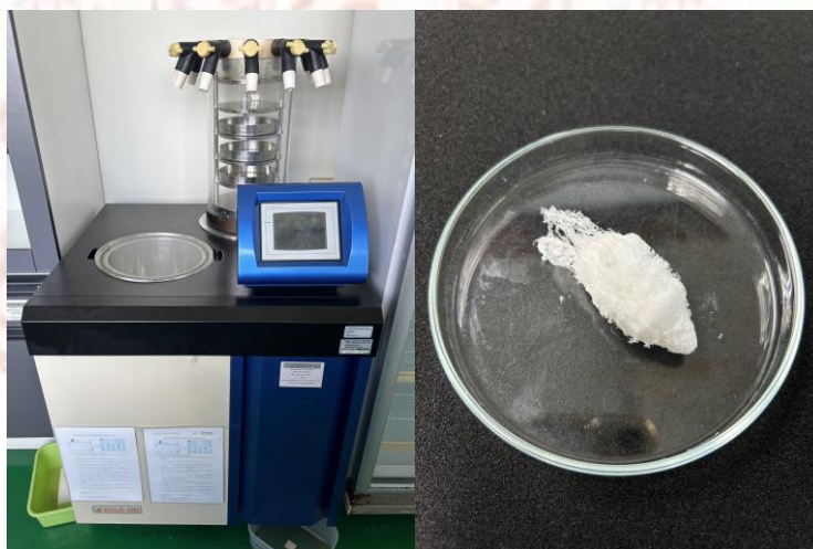
ภาพที่ 3-8 การทำให้ตัวอย่างแห้งด้วยเครื่องทำให้แห้งแบบแช่เยือกแข็ง (Freeze Dryer)
