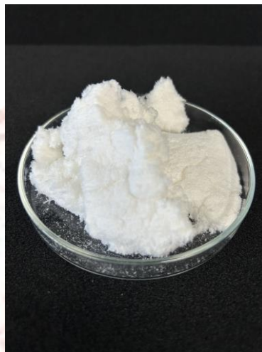
ภาพที่ 3-5 เซลลูโลสของไม้ยางพาราที่ผ่านการบดละเอียด
