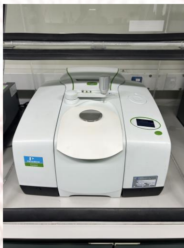
ภาพที่ 3-11 เครื่องอินฟราเรดสเปกโตรโฟโตมิเตอร์ ยี่ห้อ PerkinElmer (ที่มา : ห้องวิจัย 53-705 คณะวิทยาศาสตร์ พลังงานและสิ่งแวดล้อม มหาวิทยาลัยเทคโนโลยีพระจอมเกล้าพระนครเหนือ วิทยาเขตระยอง)
