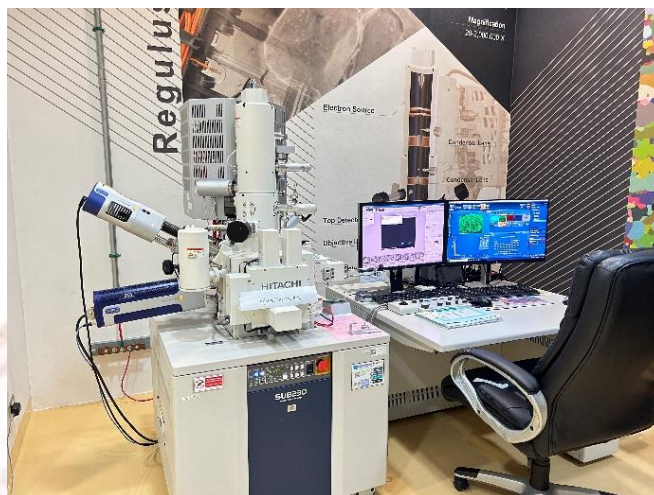
ภาพที่ 3-14 กล้องจุลทรรศน์อิเล็กตรอนแบบส่องกราด ยี่ห้อ HITACHI (ที่มา : ศูนย์บริการวิเคราะห์ทดสอบ NSTDA Characterization and Testing Service Center (NCTC))
