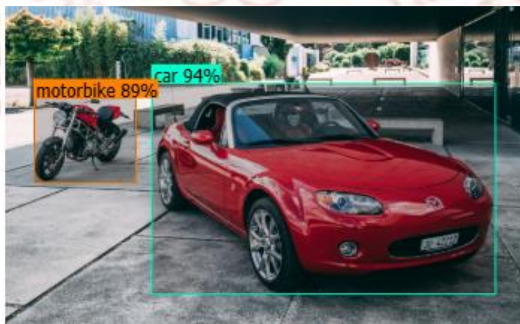
ภาพที่ 2-2 ตัวอย่างการตรวจจับ (Detection) ยานพาหนะประเภทต่างๆ ของ YOLO
