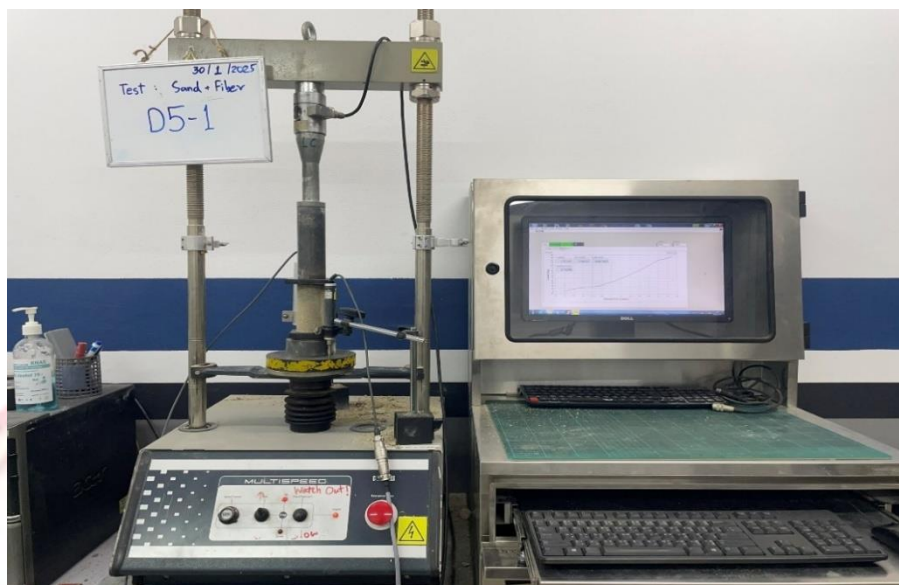
ภาพที่ 3-10 ตัวอย่างการทดสอบทรายซีเมนต์บดอัด ที่ 28 วัน แบบไม่ถูกจำกัด
