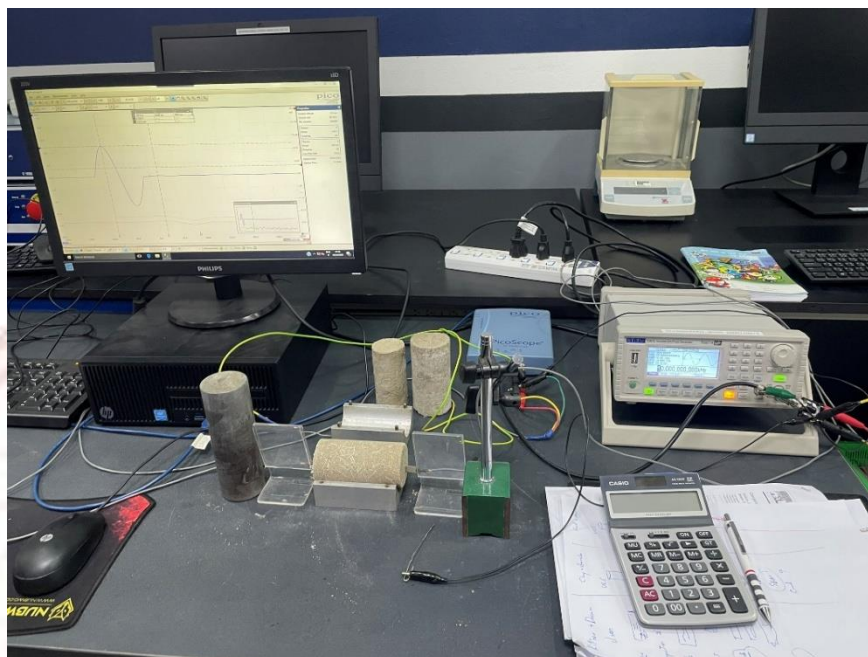
ภาพที่ 3-12 ตัวอย่างทรายซีเมนต์บดอัดทดสอบโดยวิธีเบนเดอร์อีลีเมนต์
