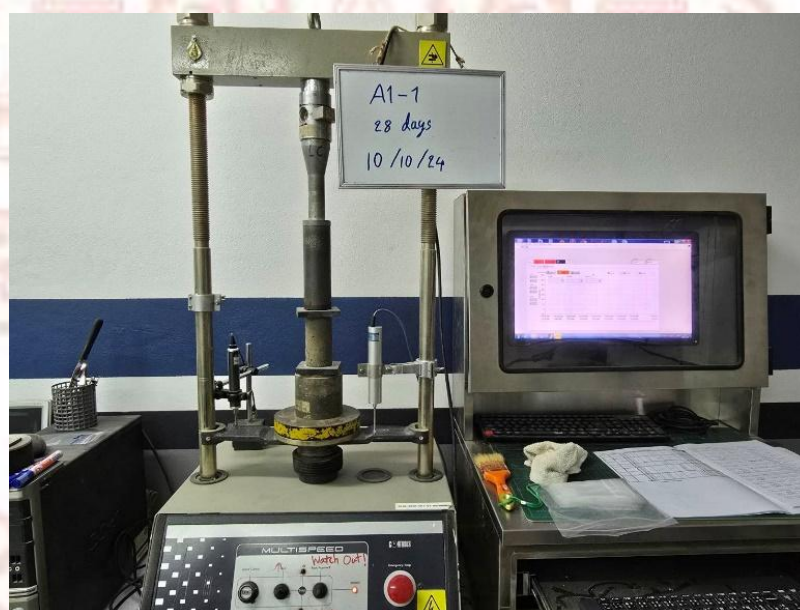
ภาพที่ 3-18 ตัวอย่างการทดสอบดินผสมกับซีเมนต์ ซิลิกาฟูมและขี้เถ้า ที่ 28 วันทดสอบแบบไม่ ถูกจำกัด
