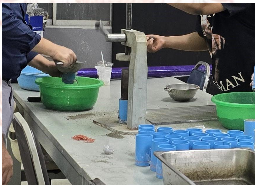
ภาพที่ 3-14 การอัดตัวอย่างดินผสมกับซีเมนต์ ชิลิกาฟุ้ง และชนไก่ลงในแบบหล่อ
