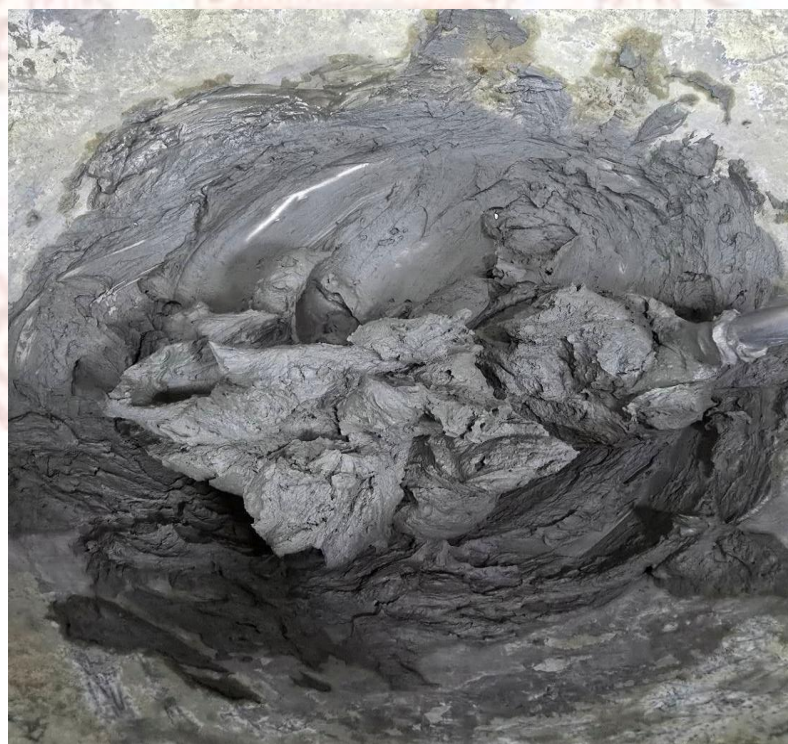
ภาพที่ 3-10 การผสมดินกับซีเมนต์ ซิลิกาฟุ่ม และขี้เถ้า
