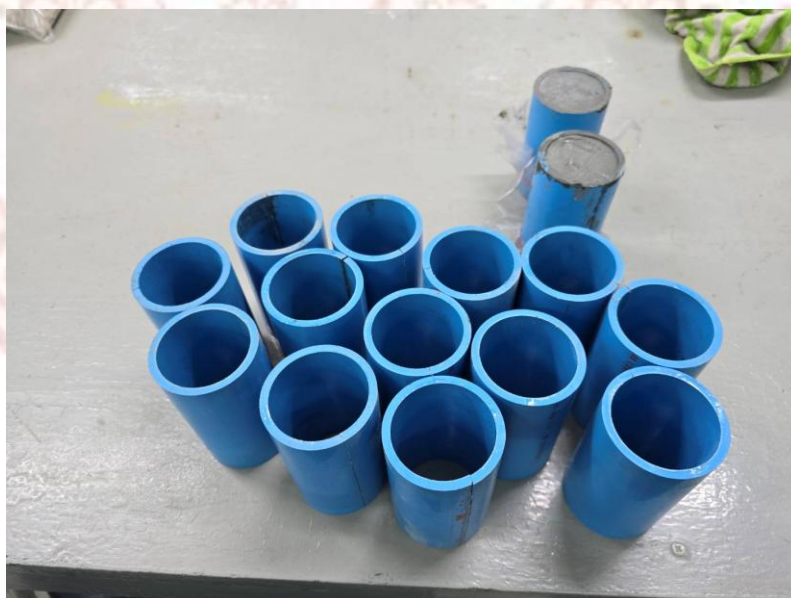
ภาพที่ 3-12 แบบหล่อตัวอย่างดินผสมกับซีเมนต์ ซิลิกาฟุ้ง และขนไก่
