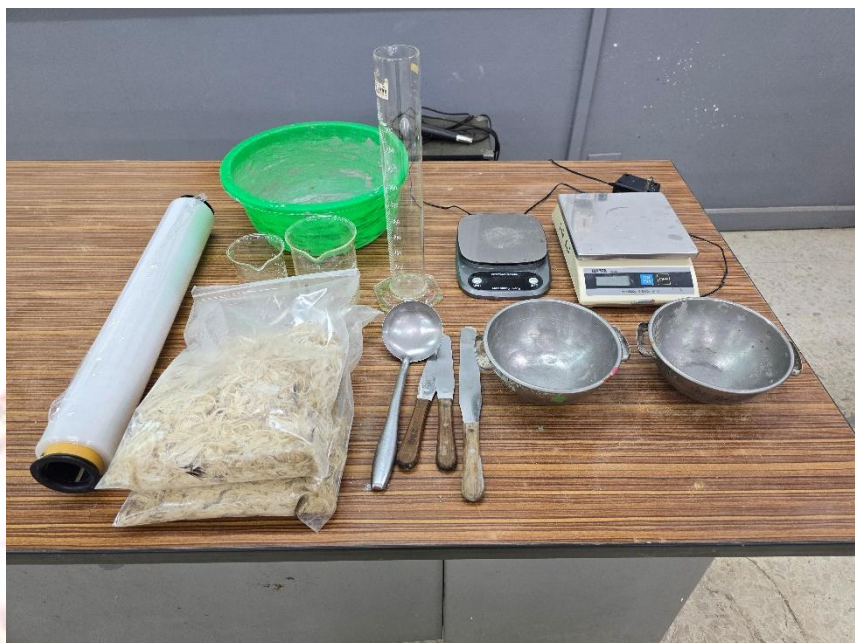
ภาพที่ 3-13 เครื่องมือและอุปกรณ์ที่ใช้ผสมดินกับซีเมนต์ ชิลิกาฟุ้ง และชนไก่
