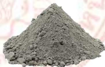
รูปที่ 3-2 ปูนซีเมนต์ปอร์ตแลนด์ประเภทที่ 1
