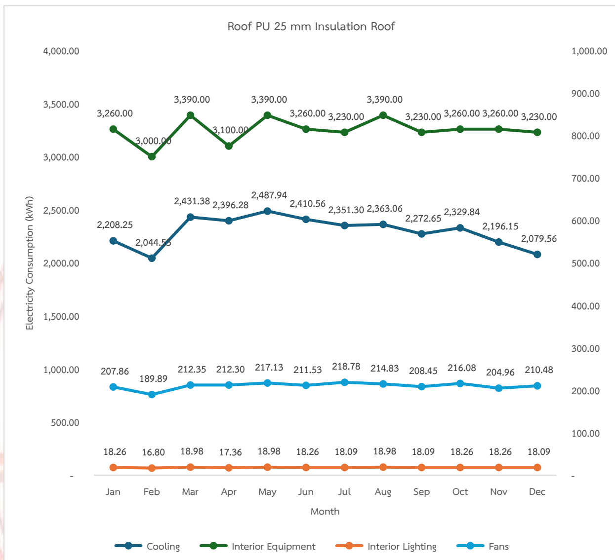
รูปที่ 4-24 การใช้พลังงานไฟฟ้ารวมของห้องคลีนรูมโดยติดฉนวนหลังคา PU 25 mm
