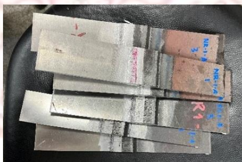
ภาพที่ 3-19 ชิ้นงานทดสอบ Fillet Break Test
