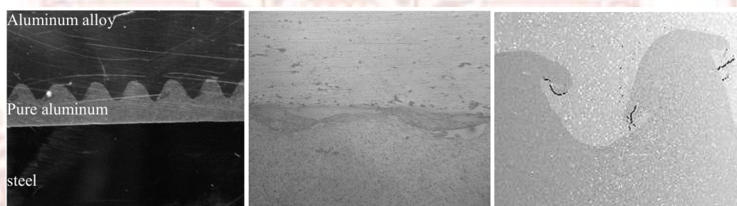
ภาพที่ 2-16 พื้นผิวรอยต่อของแผ่นวัสดุที่เคลือบด้วยกระบวนการเชื่อมระเบิด
