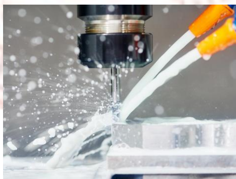
ภาพที่ 2-15 การใช้น้ำยาหล่อเย็นในการกัด
