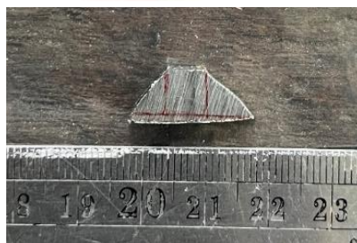
ภาพที่ 3-17 ชิ้นงานสำหรับวิเคราะห์ด้วยเทคนิค XRD
