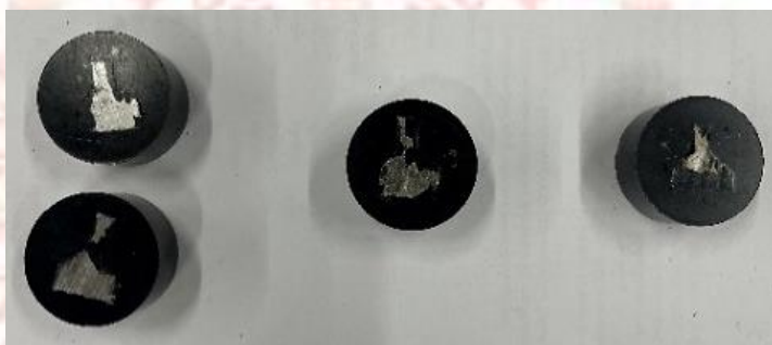
ภาพที่ 3-16 ชิ้นงานสำหรับวิเคราะห์โครงสร้างมหภาคและจุลภาค
