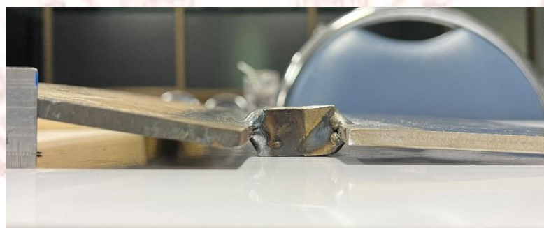
ภาพที่ 4-19 การโก่งงอของชิ้นงานทดลอง
