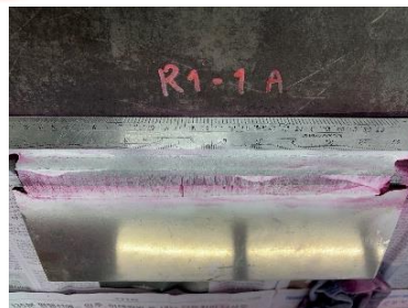
ภาพที่ 3-15 การตรวจสอบด้วยสารแทรกซึม
