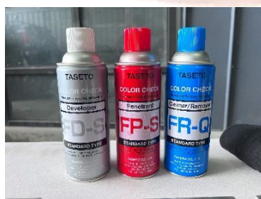
ภาพที่ 3-15 การตรวจสอบด้วยสารแทรกซึม
