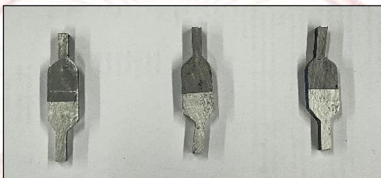
ภาพที่ 3-18 ชิ้นงานทดสอบค่าความแข็ง
