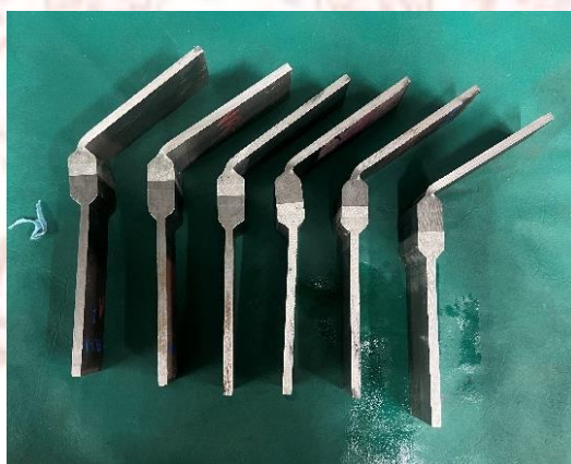
ภาพที่ 4-24 ชิ้นงานทดสอบ Fillet Break Testing
