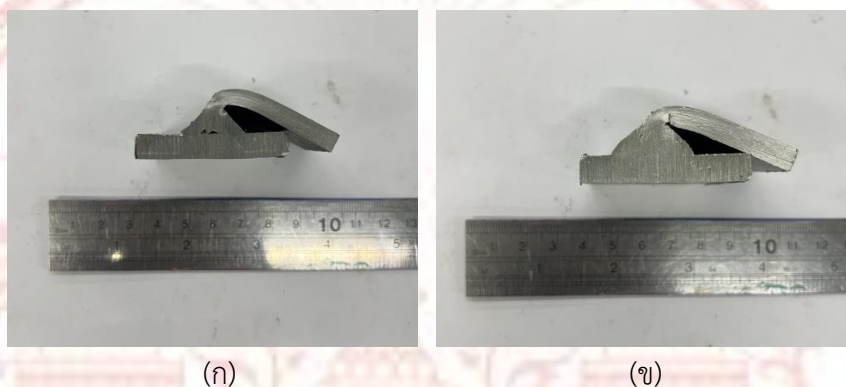
ภาพที่ 4-6 ภาพตัดขวางของขึ้นงานเชื่อมหลังการทดสอบ Fillet Break Test
