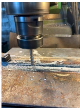
ภาพที่ 3-13 การกัดโลหะซ่อมชิ้นงานทดลอง และ เครื่องกัดโลหะแนวตั้ง
