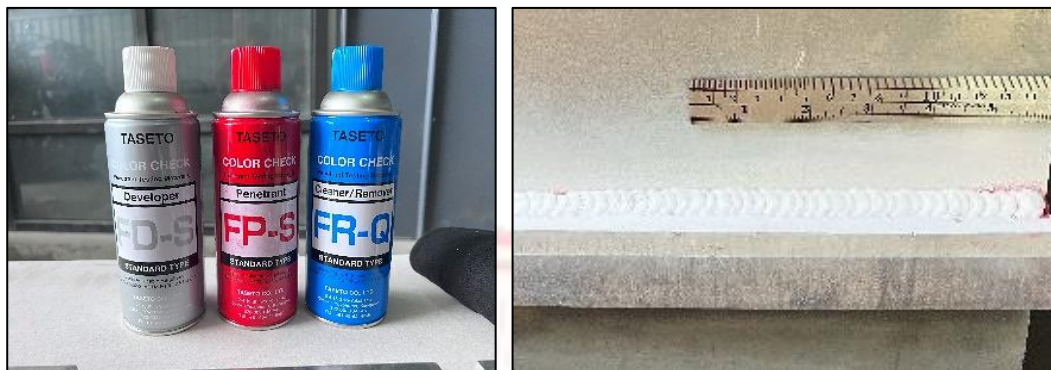
ภาพที่ 3-6 การตรวจสอบด้วยสารแทรกซึม ประกอบด้วย
