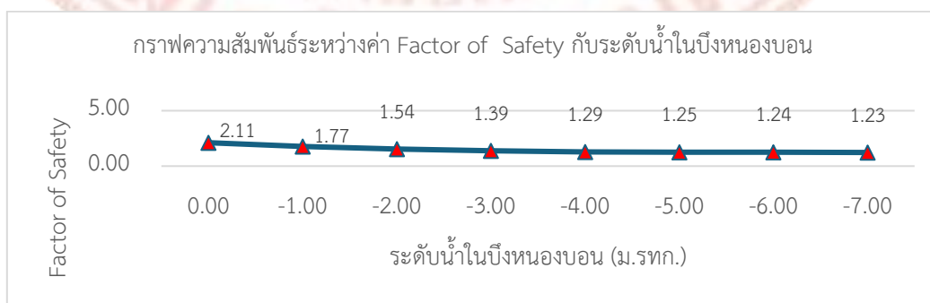
ภาพที่ 4-1 กราฟความสัมพันธ์ระหว่างค่า Factor of Safety กับระดับน้ำในบึงหนองบอน ของ Sta.4+700
