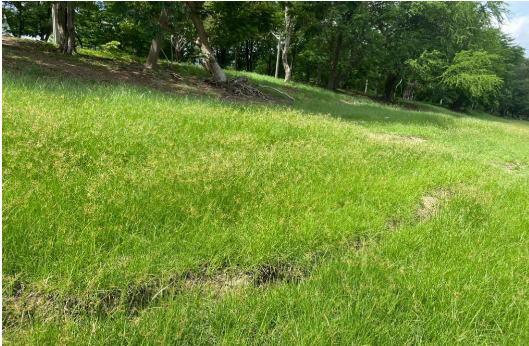
ภาพ ข-5 การเคลื่อนตัวของดินที่ตรวจวัดจริงของ Sta.4+700
