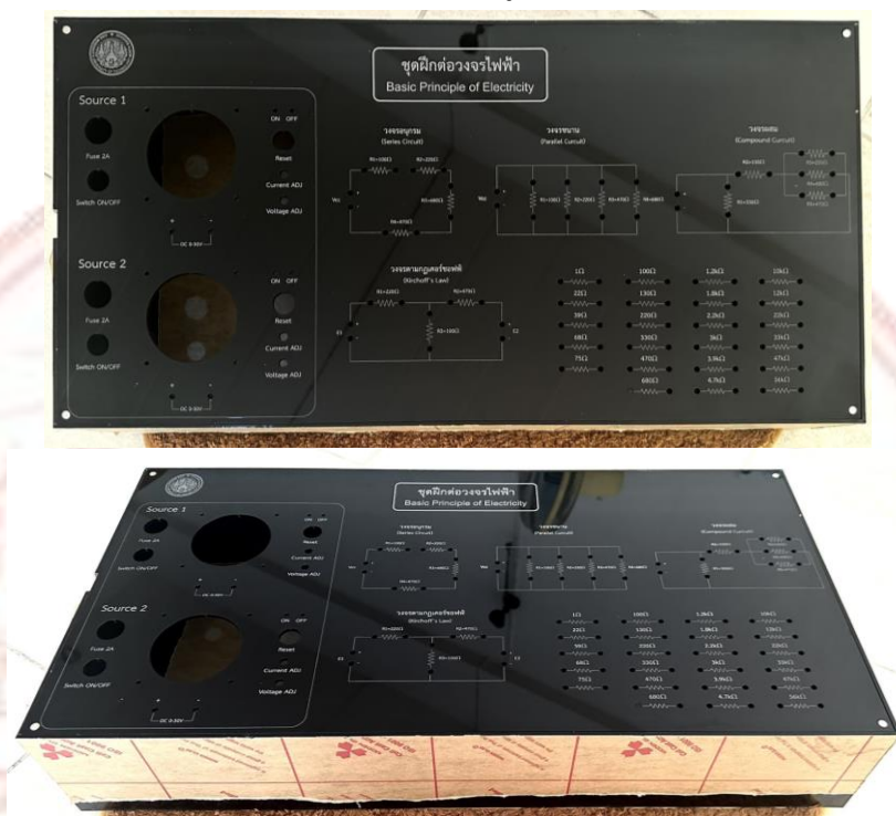
ภาพที่ 3-3 ตัดกล่องอะคริลิกและเจาะรูตามการออกแบบ
