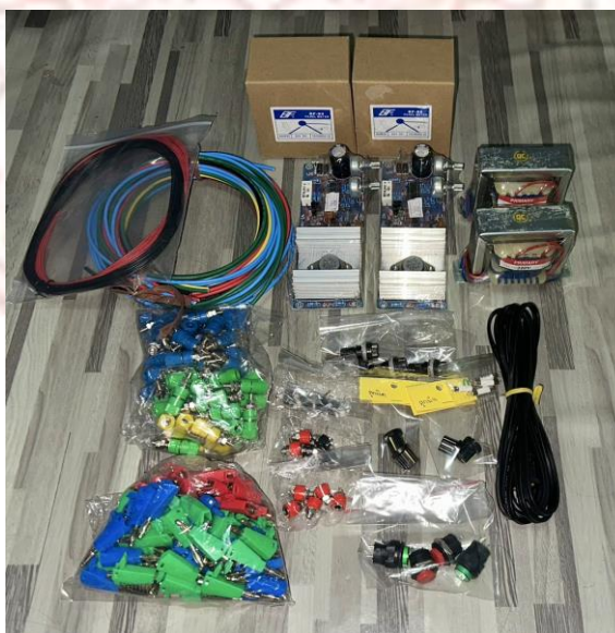
ภาพที่ 3-4 วัสดุอุปกรณ์ของชุดฝึกต่อวงจรไฟฟ้า
