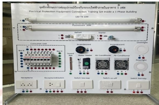
ภาพที่ 4-1 ชุดฝึกทักษะการต่ออุปกรณ์ป้องกันระบบไฟฟ้าภายในอาคาร 1 เฟส
