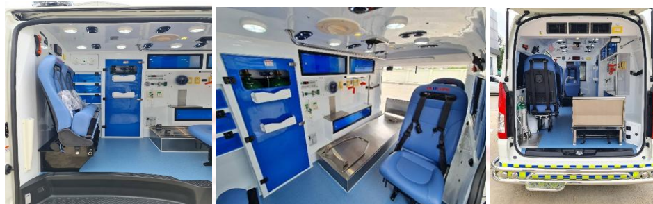
ภาพที่ 1-3 การประกอบตกแต่งอุปกรณ์ภายในโดยสารตอนหลังรถพยาบาลฉุกเฉิน (ที่มา : ข้อมูลรูปประกอบรถพยาบาลแผนกวิศวกรรมปี 2566)
