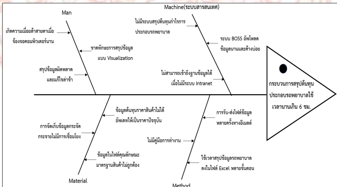
ภาพที่ 3-6 แผนภาพผังก้างปลาแสดงการวิเคราะห์สาเหตุของปัญหาด้วยหลัก 4 M
