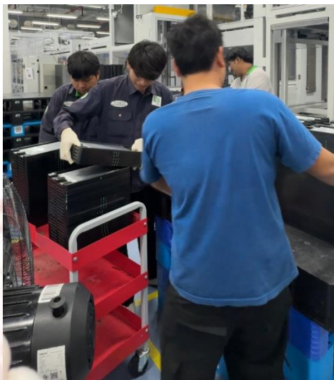
ภาพที่ 4-4 กระบวนการยก cell rework ของพนักงานหลังจากปรับปรุงตามหลักการยศาสตร์
