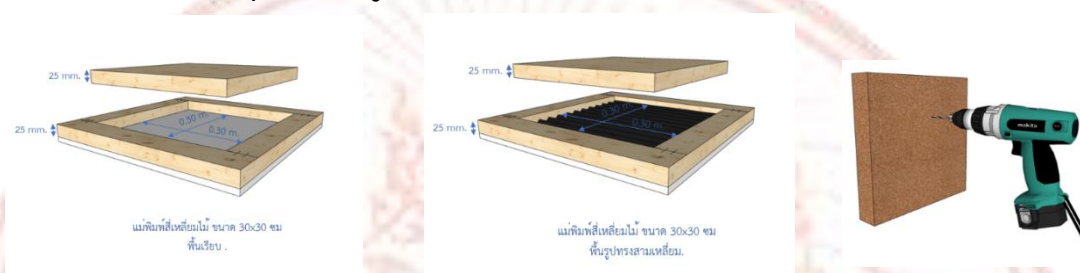
ภาพที่ 3-10 แม่พิมพ์ไม้สี่เหลี่ยม 30x30 พื้นเรียบ พื้นแบบพื้นปลา และวิธีเจาะรูแผ่นวัสดุซับเสียง
