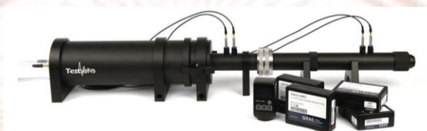
ภาพที่ 3-14 เครื่องทดสอบสัมประสิทธิ์การดูดซับเสียง ( https://bias.com. )
