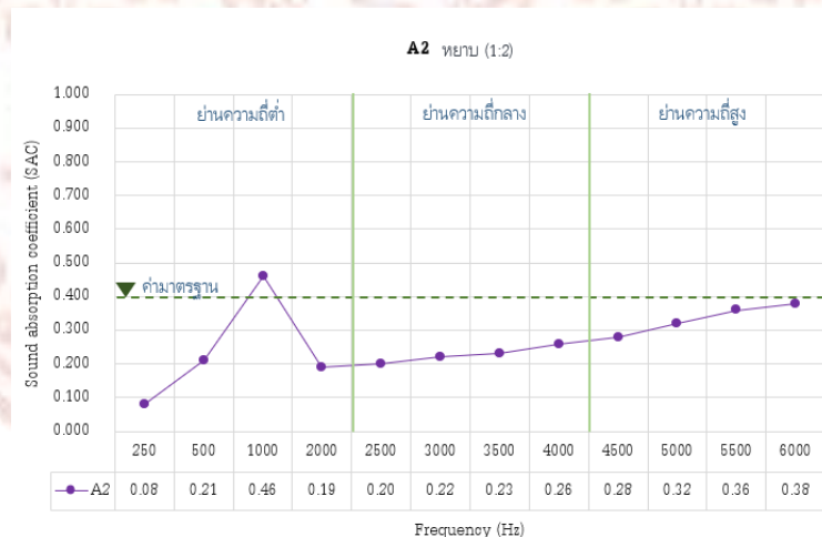
ภาพที่ 4-3 ค่าสัมประสิทธิ์การดูดซับเสียง ชิ้นงาน A2
