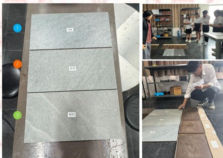
รูปที่ 4-5 กระเบื้องที่มีค่ากันความลื่น (ซ้าย) ทดสอบความลื่น (ขวา)
