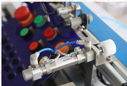
ภาพที่ 2-17 กระบอกสูบนิวเมติกสำหรับดันชิ้นงาน
