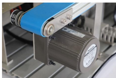
ภาพที่ 2-15 มอเตอร์ไฟฟ้าในระบบสายพานลำเลียง
