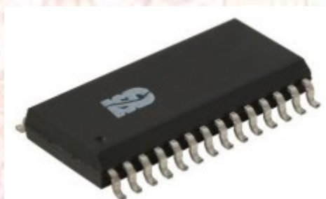
ภาพที่ 2-4 โครงสร้างแบบ SOIC (วิโรจน์ กิตติวรปรีดา, 2560)
