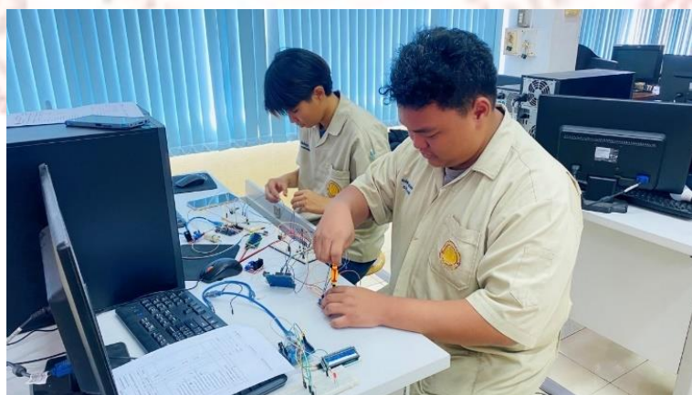
ภาพที่ 4-4 ผู้เรียนทำการปฏิบัติในการต่อวงจร และเขียนโปรแกรมควบคุมมอเตอร์ในการควบคุมในการสร้างสัญญาณพัลส์วืตม์อดูล์ชันจากไมโครคอนโทรลเลอร์ในการควบคุมมอเตอร์
