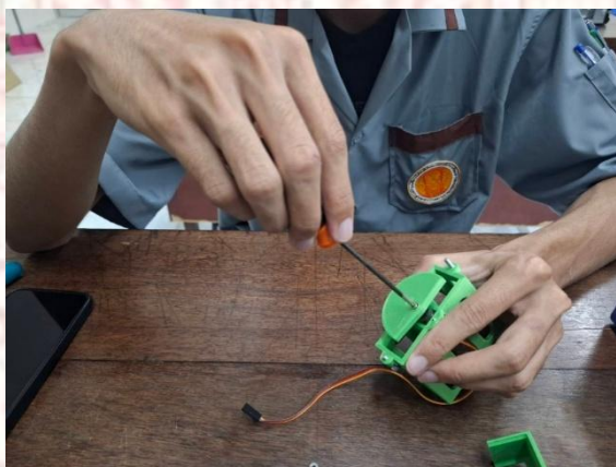
ภาพที่ 7-3 การยึดใบดันลูกบาศก์เข้ากับแกนหมุนของเซอร์โวมอเตอร์
