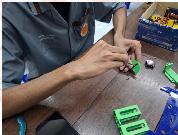
ภาพที่ 7-1 การประกอบใบด้นลูกบาศก์เข้ากับปีกเซอร์โวมอเตอร์
