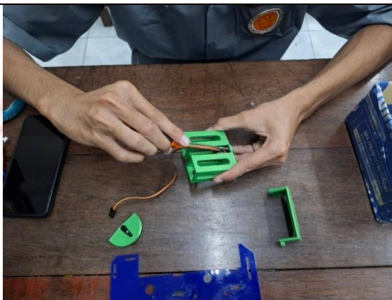
ภาพที่ 7-2 การยึดเซอร์โวมอเตอร์เข้ากับโครงชุดปล่อยลูกบาศก์ส่วนบน
