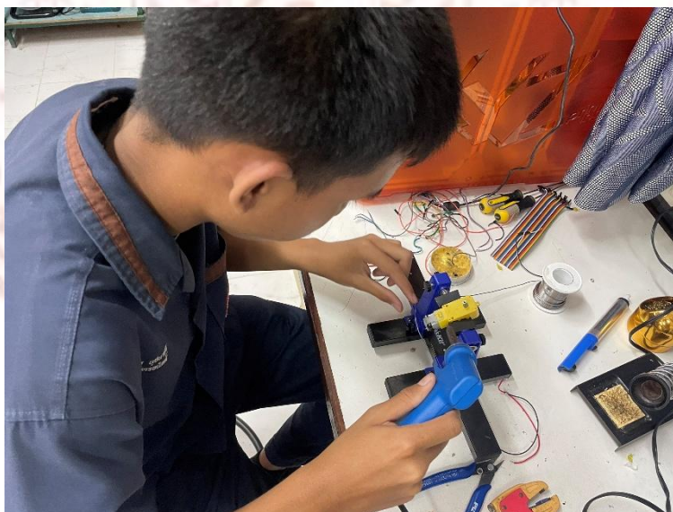
ภาพที่ ข-11 ภาพการทำสายเชื่อมต่อมอเตอร์กับบอร์ดคอนโทรลเลอร์
