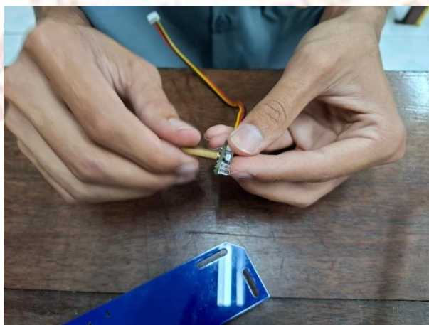
ภาพที่ 7-14 การใส่สเปซเซอร์แล้วยัดน็อตเข้ากับเซนเซอร์ IR
