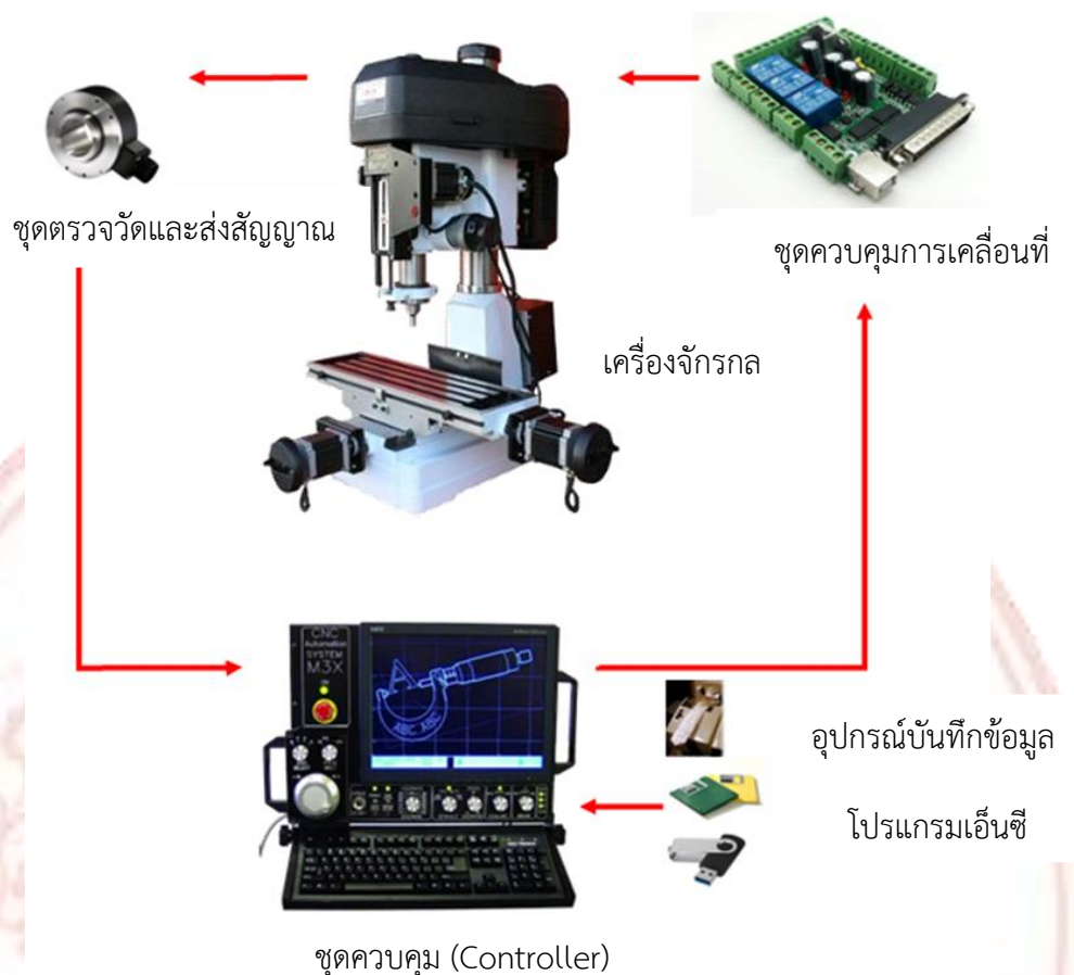
ภาพที่ 3-4 หลักการทำงานของเครื่องจักรกลซีเอ็นซี ( http://www.tl.ac.th/document/chatchai/cnc1.pdf )
