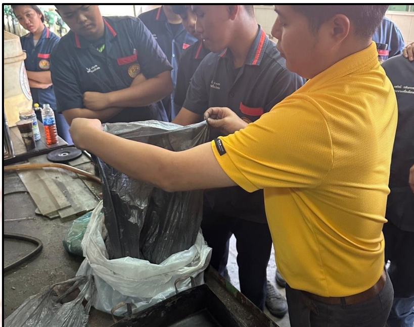
รูปที่ ก-6 แนะนำขั้นตอนการเตรียมสารในการเพิ่มคาร์บอนให้แก่เหล็กกล้าคาร์บอนต่ำ
