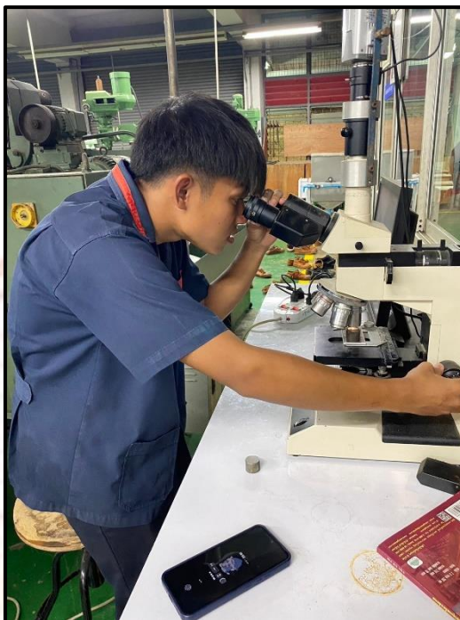
รูปที่ ก-8 ผู้เรียนตรวจสอบโครงสร้างของเหล็กหลังกระบวนการเพิ่มคาร์บอนให้แก่เหล็กกล้าคาร์บอนต่ำแล้ว
