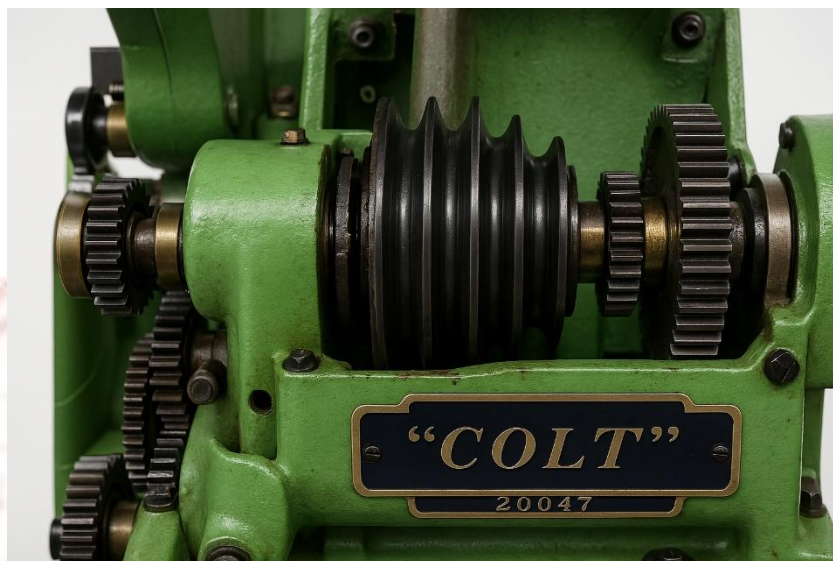
ภาพที่ 2-6 การส่งกำลังด้วยสายพาน
