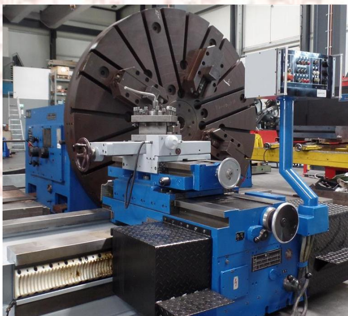
ภาพที่ 2-4 เครื่องกลึงเทอเลส (ที่มา https://machine.co.th/ )
