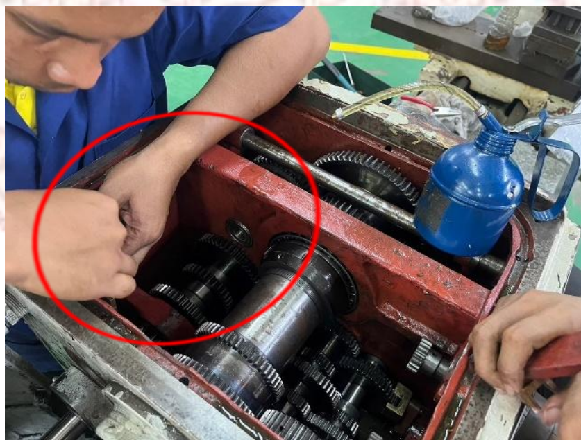
ภาพที่ 3-14 ถอดสลักก้ามปู
