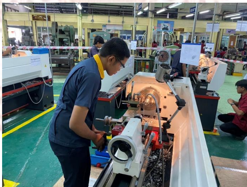
ภาพที่ 3-32 กลึงชิ้นงานเพื่อตรวจสอบระบบส่งกำลัง
