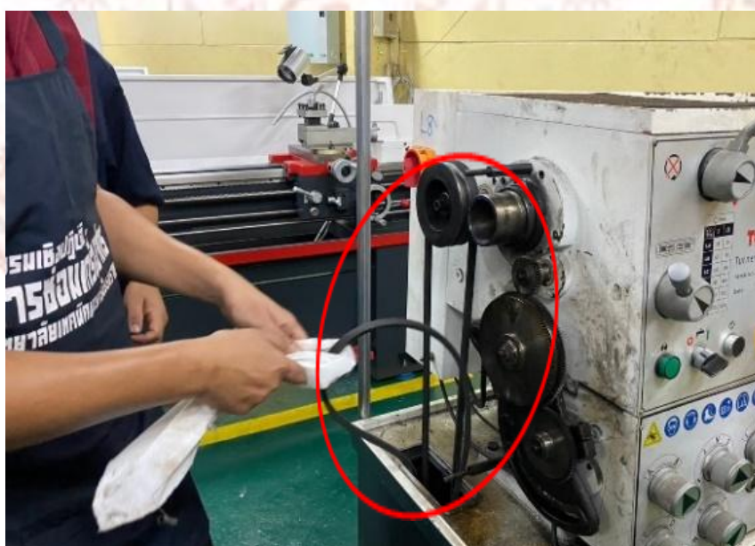
ภาพที่ 3-8 ถอดสายพานมอเตอร์
