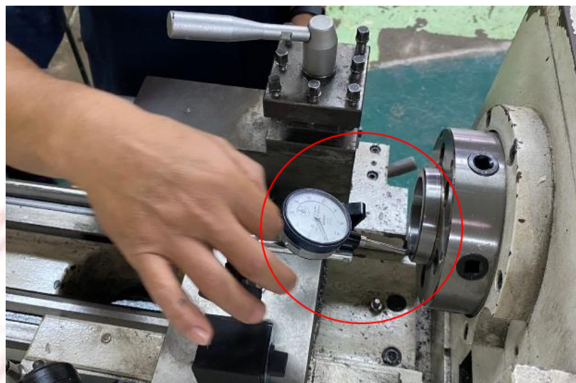
ภาพที่ 3-29 ตรวจสอบค่าความเที่ยงของเพลสปินเดิล
