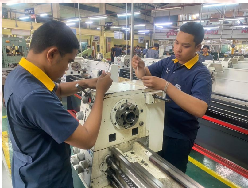
ภาพที่ ก-4 การซ่อมบำรุงชุดเฟืองส่งกำลังของเครื่องกลึง
