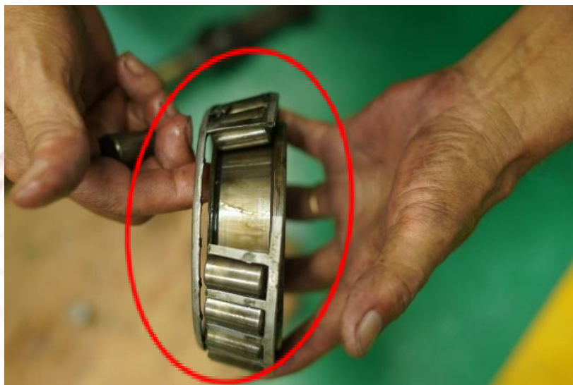
ภาพที่ 3-17 ซ่อมบำรุงชุดตลับลูกปืนเตเปอร์
