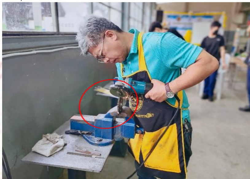
ภาพที่ 3-19 ซ่อมบำรุงเฟือง
