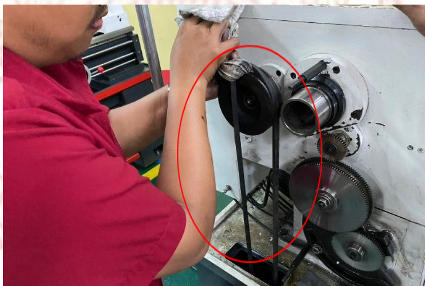
ภาพที่ 3-28 ประกอบสายพานมอเตอร์
