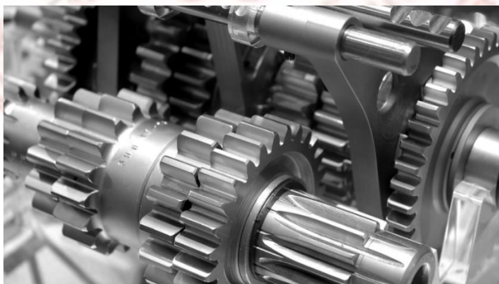
ภาพที่ 2-7 การส่งถ่ายกำลังด้วยชุดเฟือง (Gear Transmission)
