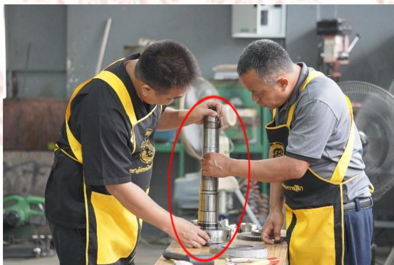
ภาพที่ 3-18 ซ่อมบำรุงเพลาสปินเดิล
