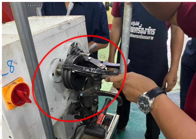
ภาพที่ 3-9 ถอดพูลเลย์เฟลาเฟืองขับ
