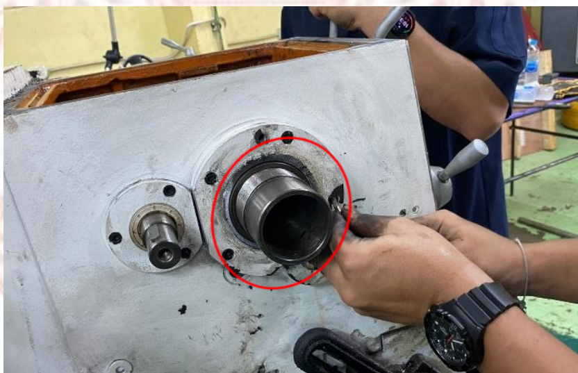
ภาพที่ 3-12 คลายนื้อยึดฝาครอบตลับลูกปืน
