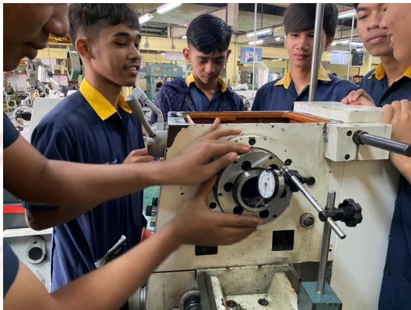
ภาพที่ ก-5 ประกอบ ทดสอบและปรับตั้งชิ้นส่วนชุดเฟืองส่งกำลังของเครื่องกลึง
