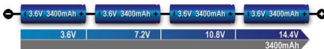
ภาพที่ 2-22 การเชื่อมต่อแบบอนุกรมของสี่เซลล์ (4s)
