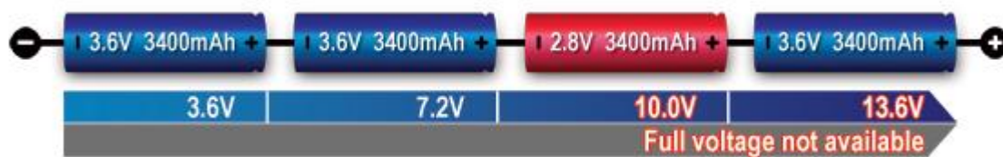
ภาพที่ 2-23 แสดงชุดแบตเตอรี่ที่ "เซลล์ที่ 3" มีแรงดันไฟฟ้าเพียง 2.8V แทนที่จะเป็น 3.6V ตามปกติ ด้วยแรงดันไฟฟ้าที่ต่ำแบตเตอรี่นี้จะถึงจุดสิ้นสุดการคายประจุเร็วกว่าก่อนปกติ แรงดันไฟฟ้าลดลงและอุปกรณ์ไฟฟ้าจะปิดตัวเอง พร้อมข้อความ "แบตเตอรี่ต่ำ"
