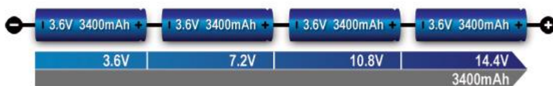
ภาพที่ 2-24 การเชื่อมต่อแบบอนุกรมของสี่เซลล์ (4s)
