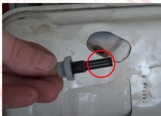
ภาพที่ ก-5 การทำความสะอาดกรองน้ำมันเชื้อเพลิง
