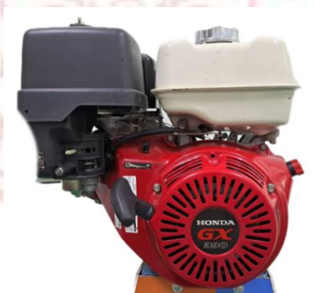
ภาพที่ ก-1 เครื่องยนต์เล็กแก๊สโซลีน 4 จังหวะ HONDA GX 390
