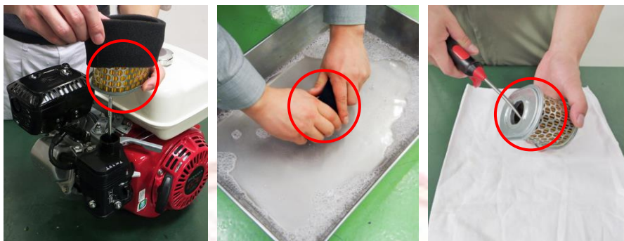
ภาพที่ ก-2 การทำความสะอาดกรองอากาศแบบแห้ง
