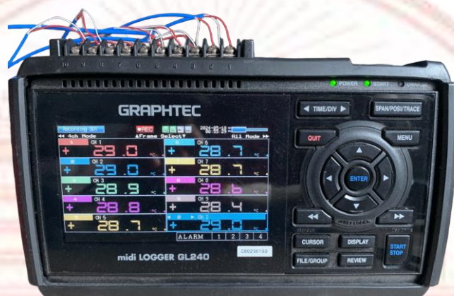
ภาพที่ 3-11 เครื่องบันทึกข้อมูลแบบอิเล็กทรอนิกส์ (Data Logger)
