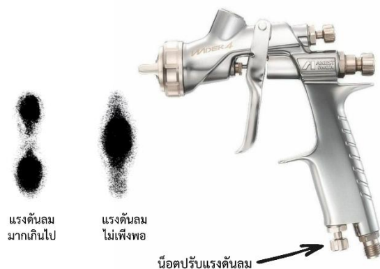
ภาพที่ 2-24 การปรับแรงดันลม
