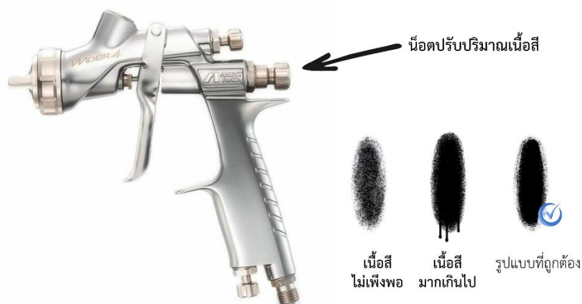
ภาพที่ 3-7 การปรับตั้งแรงดันลมและการไหลของสี
