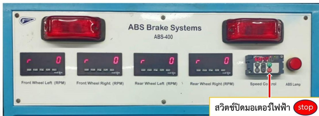
ภาพที่ 3-14 สวิตช์ควบคุมมอเตอร์ไฟฟ้า (ปิด) ชุดฝึกทักษะระบบป้องกันเบรกล้อค
