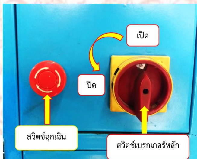
ภาพที่ 3-15 สวิตช์เบรกเกอร์หลักชุดฝึกทักษะระบบป้องกันเบรกล้อค
