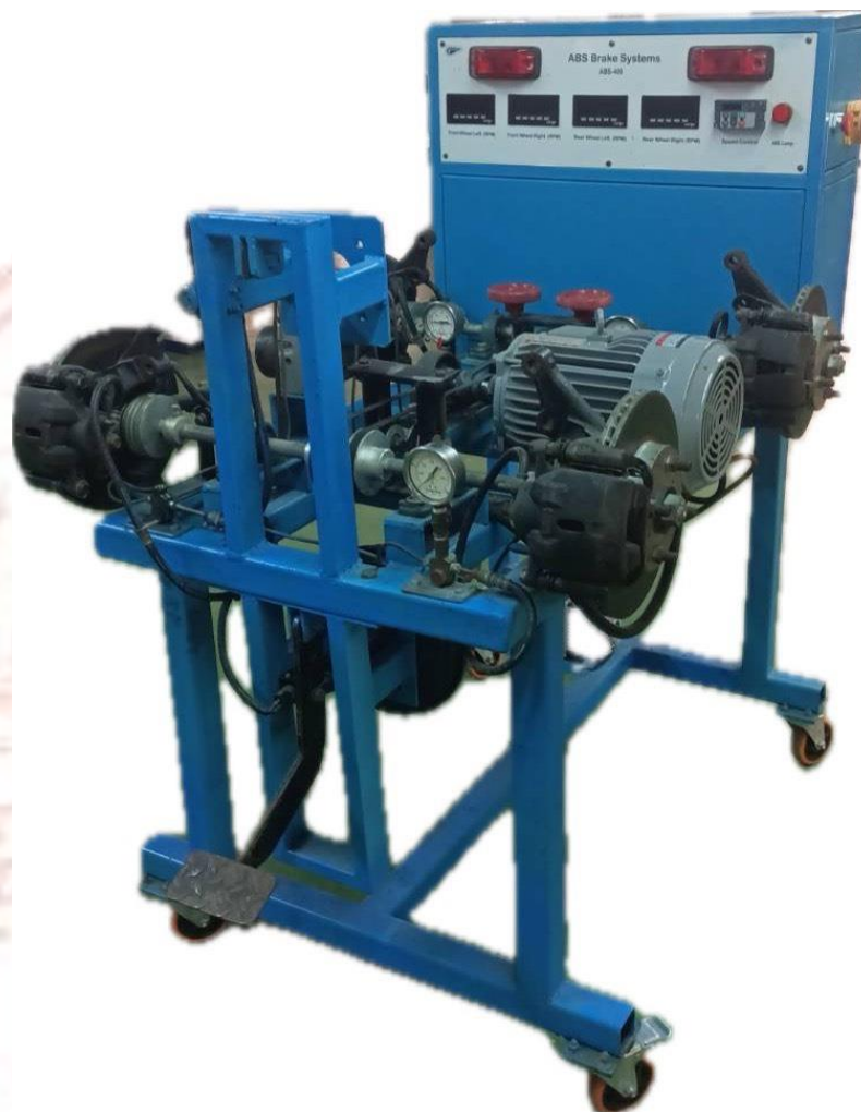
ภาพที่ 3-6 ชุดฝึกทักษะระบบป้องกันเบรกล้อคที่ได้รับการพัฒนา
