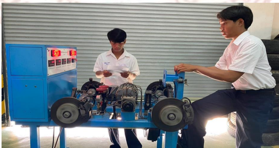
ภาพที่ 3-13 ทดสอบการทำงานของชุดฝึกทักษะระบบป้องกันเบรกลื่น
