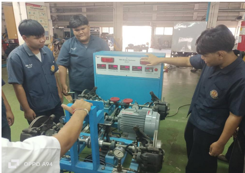
ภาพที่ ง-5 นักเรียนปฏิบัติการทดสอบการทำงานของระบบเบรกด้วยชุดฝึกทักษะ
