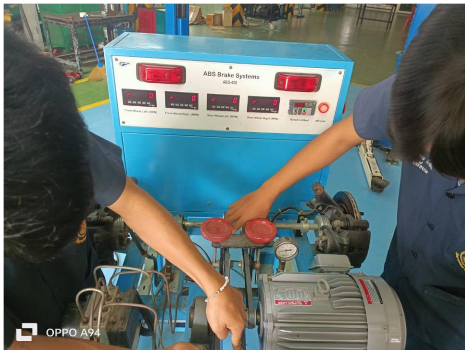
ภาพที่ ง-3 นักเรียนปฏิบัติงานปรับตั้งสายพานชุดฝึกทักษะระบบป้องกันเบรกล้อค
