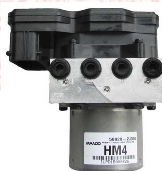
ภาพที่ 2-12 ชุดควบคุมแรงดัน
