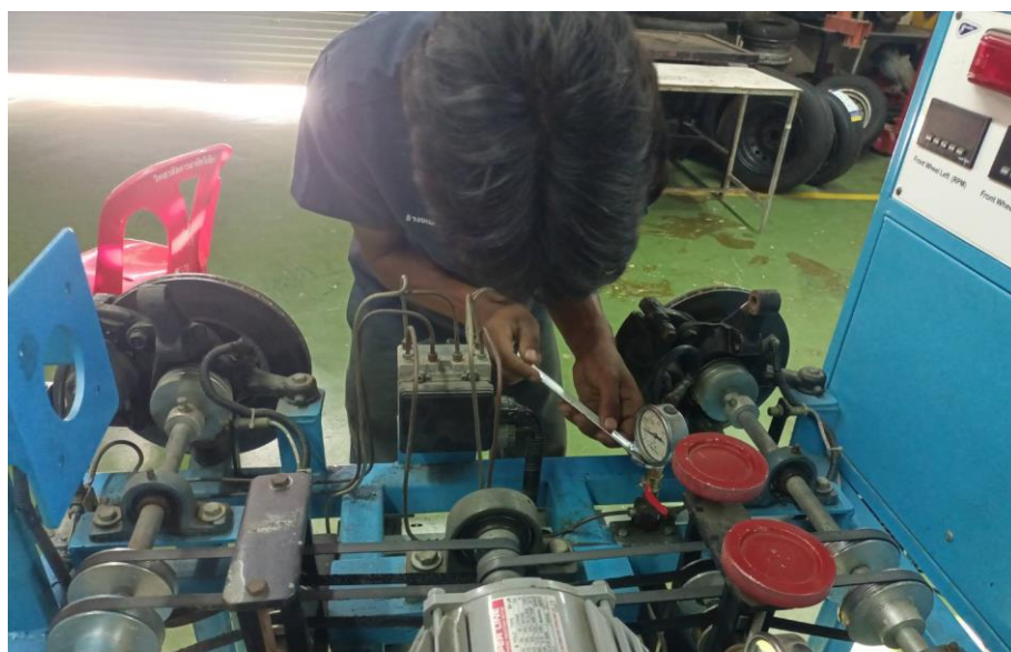
ภาพที่ 3-5 ประกอบชิ้นส่วน อุปกรณ์ ชุดฝึกทักษะระบบป้องกันเบรกลอค
