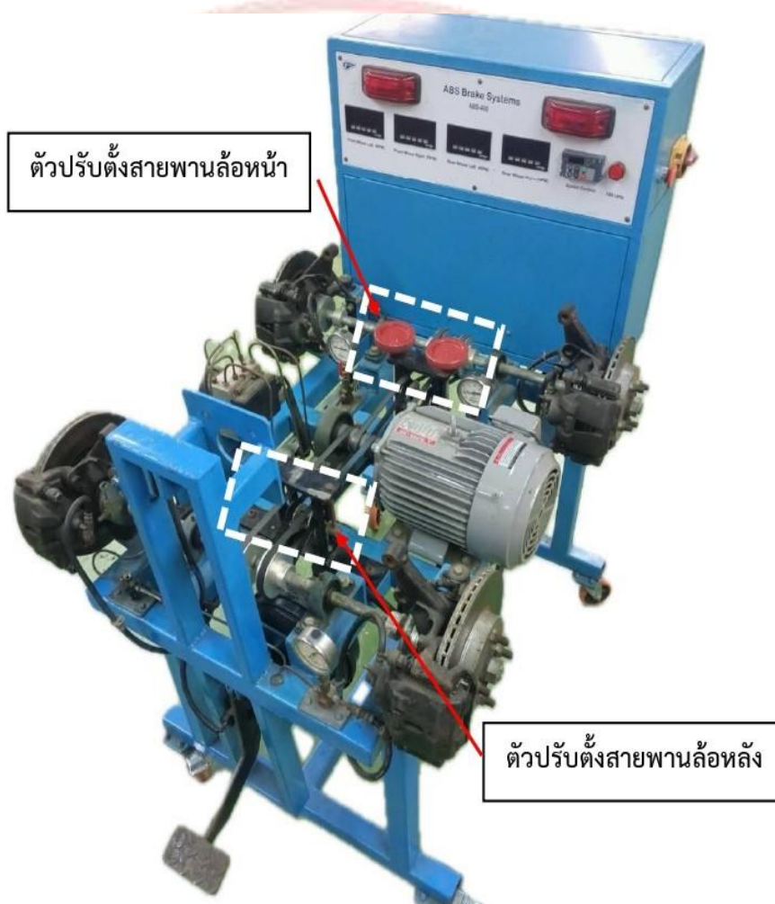
ภาพที่ 3-9 ตัวปรับตั้งความตึงของสายพานขับเพลาล้อชุดฝึกทักษะ
