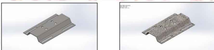
ภาพที่ 2.1 การขึ้นรูปและการสร้างเอลิเมนต์สำหรับปัญหาแบบสามมิติ
