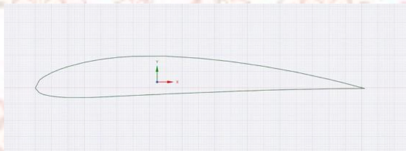
ภาพที่ 3.6 รูปทรงแพนอากาศ NACA 4412 สร้างขึ้นโดยใช้โปรแกรม SpaceClaim
