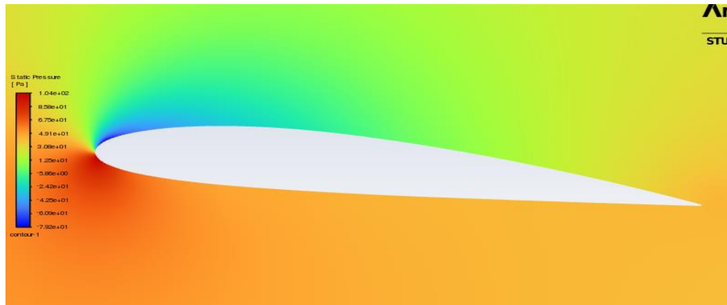
ภาพที่ ค.4 แสดงวิธีสีความดันของแพนอากาศ NACA2412 ที่มุมปะทะ 6° ด้วยความเร็ว 5 m/s
