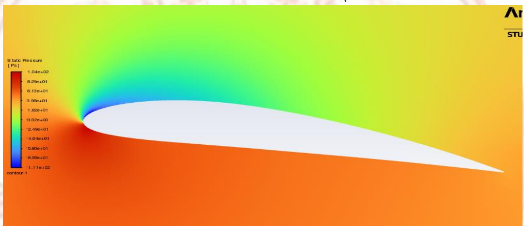
ภาพที่ ฉ.5 แสดงวิธีสีความดันของแพนอากาศ NACA4412 ที่มุมปะทะ 8° ด้วยความเร็ว 5 m/s
