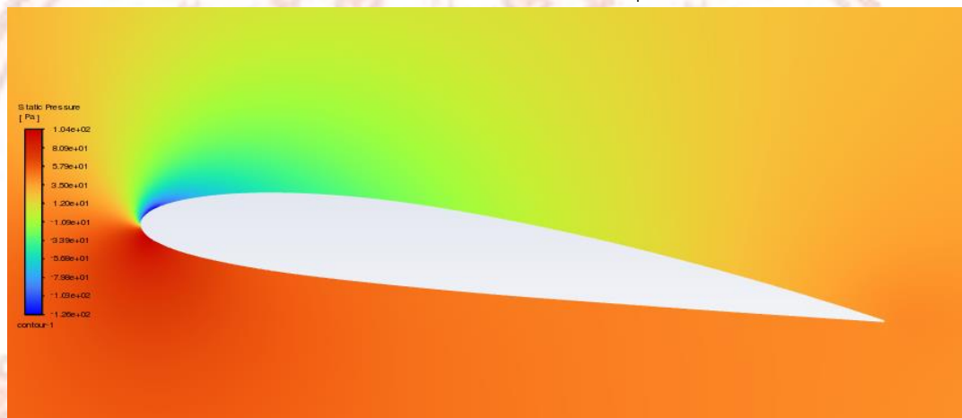
ภาพที่ ค.5 แสดงวิธีสีความดันของแพนอากาศ NACA2412 ที่มุมปะทะ 8° ด้วยความเร็ว 5 m/s
