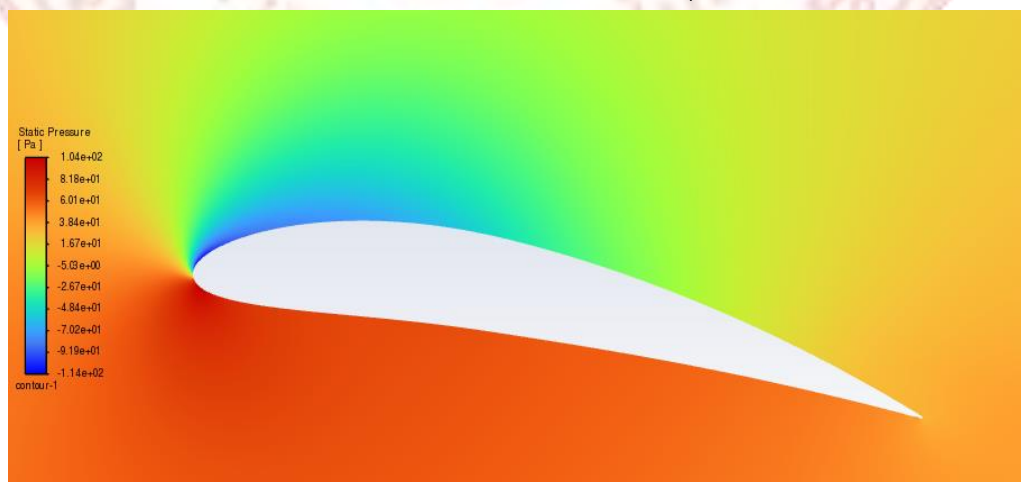
ภาพที่ ฅ.4 แสดงรื้สืความดันของแพนอากาศ NACA6412 ที่มุมปะทะ 6° ด้วยความเร็ว 5 m/s
