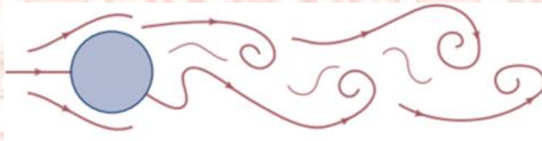
ภาพที่ 2.21 แสดงลักษณะการเกิด Von Karman vortex street หลังวัตถุรูปทรงกระบอก (Garhart et al, 2019 : 524)
