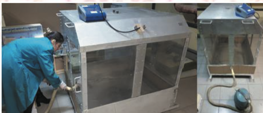
รูปที่ 2.7 การติดตั้งชุดอุปกรณ์ทดสอบประสิทธิภาพในการกำจัดฝุ่นโดยการฉีดพ่นโซเดียมคาร์บอกซีเมทิลเซลลูโลส [13]
