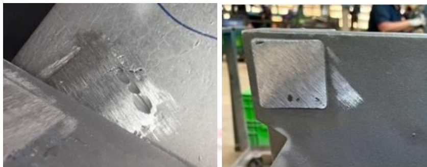
ภาพที่ 3-22 จุดข้อบกพร่องประเภทโพรงหดตัวในเนื้อชิ้นงาน
