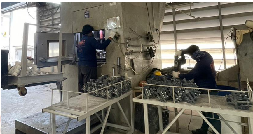
ภาพที่ 3-10 ขั้นตอนการกระแทกเปลือก
