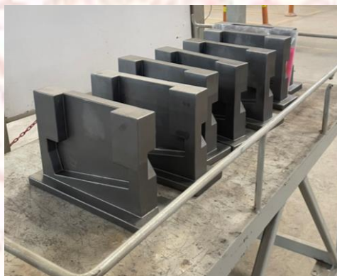
ภาพที่ 3-11 ชิ้นงานที่ถูกตัดระบบป้อนเดิมออกแล้ว
